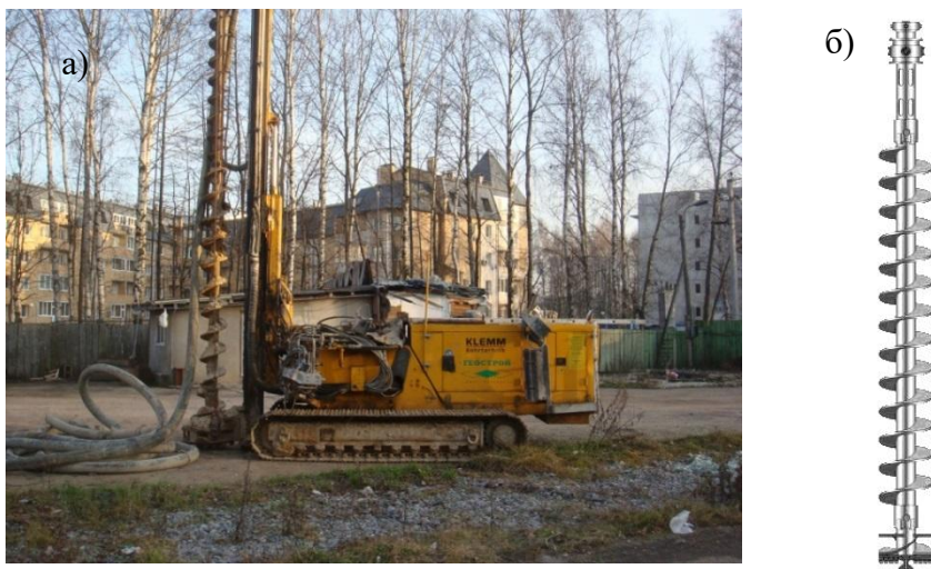
Рис. 4.19. Буровая установка для изготовления свай с использованием непрерывного проходного шнека (а) и непрерывный проходной шнек (б)
