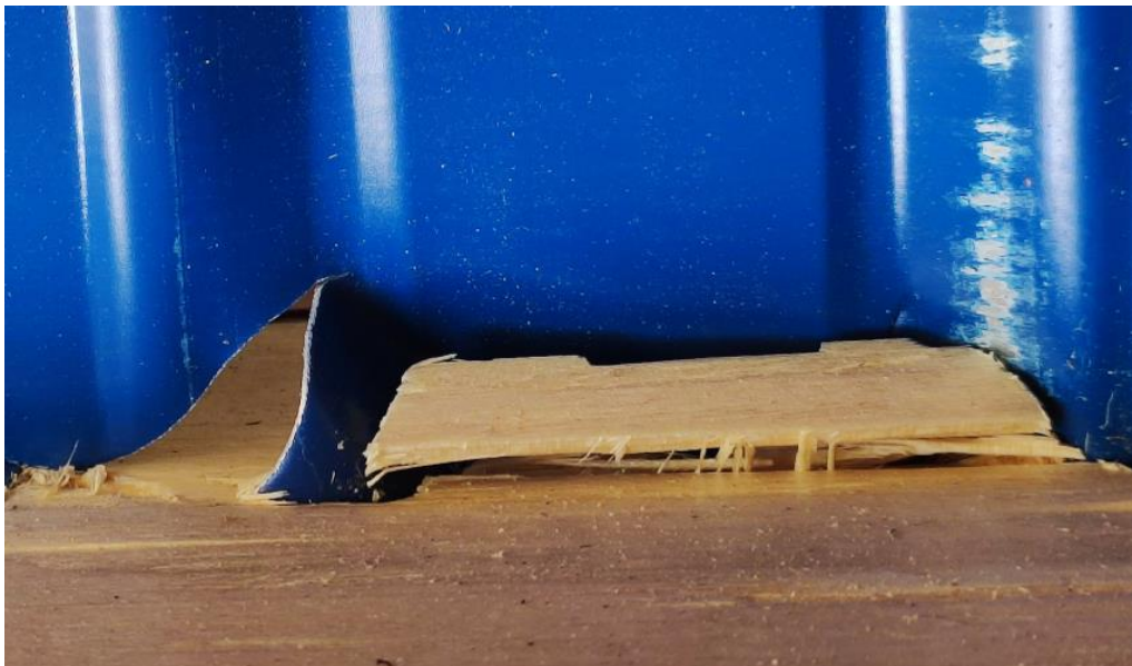
Рисунок 3.35 – Повреждения по материалу стенки (сталь) испытываемых балок – разрыв металла вблизи зуба.
