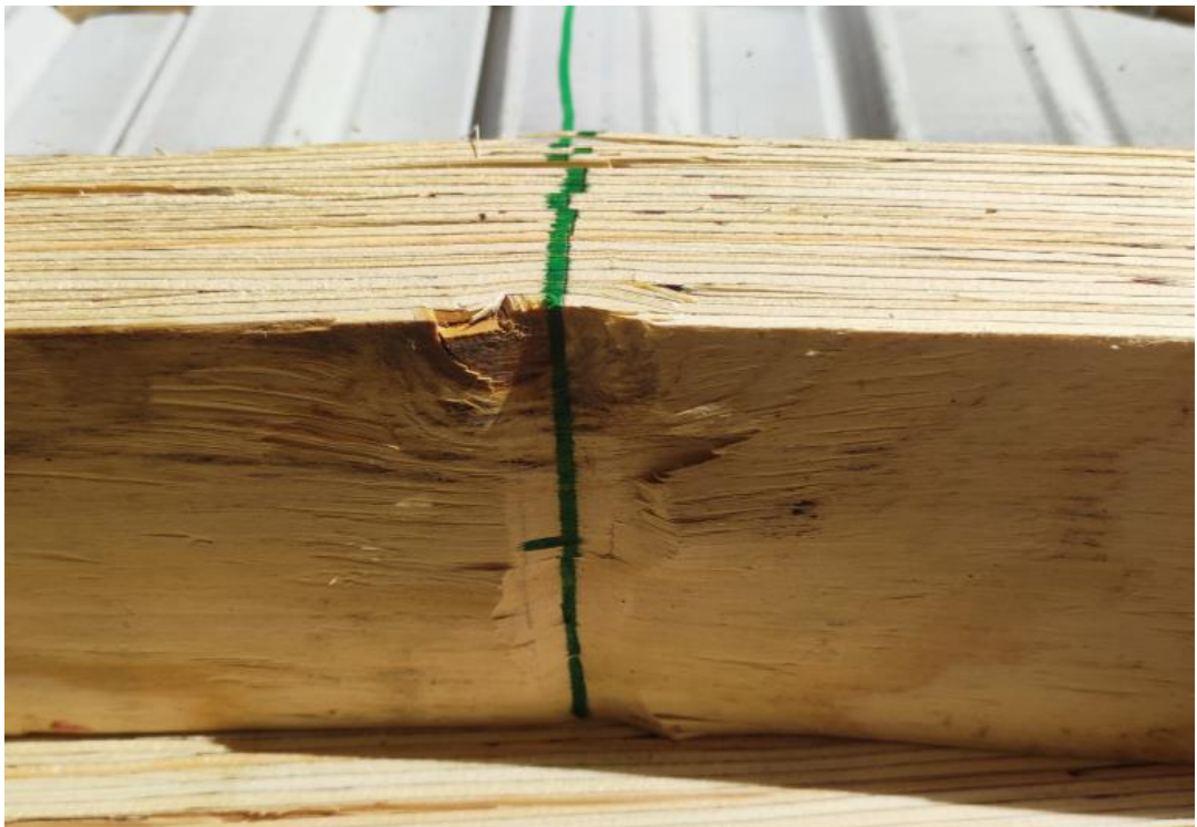
Рисунок 3.33 – Повреждения по материалу поясов (LVL) испытываемых балок – смятие поперек волокон из плоскости слоев шпона в опорных зонах и в местах приложения нагрузки.
