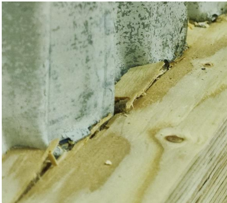
Рисунок 3.31 – Повреждения по материалу поясов (LVL) испытываемых балок – скалывание древесины между зубьями.
