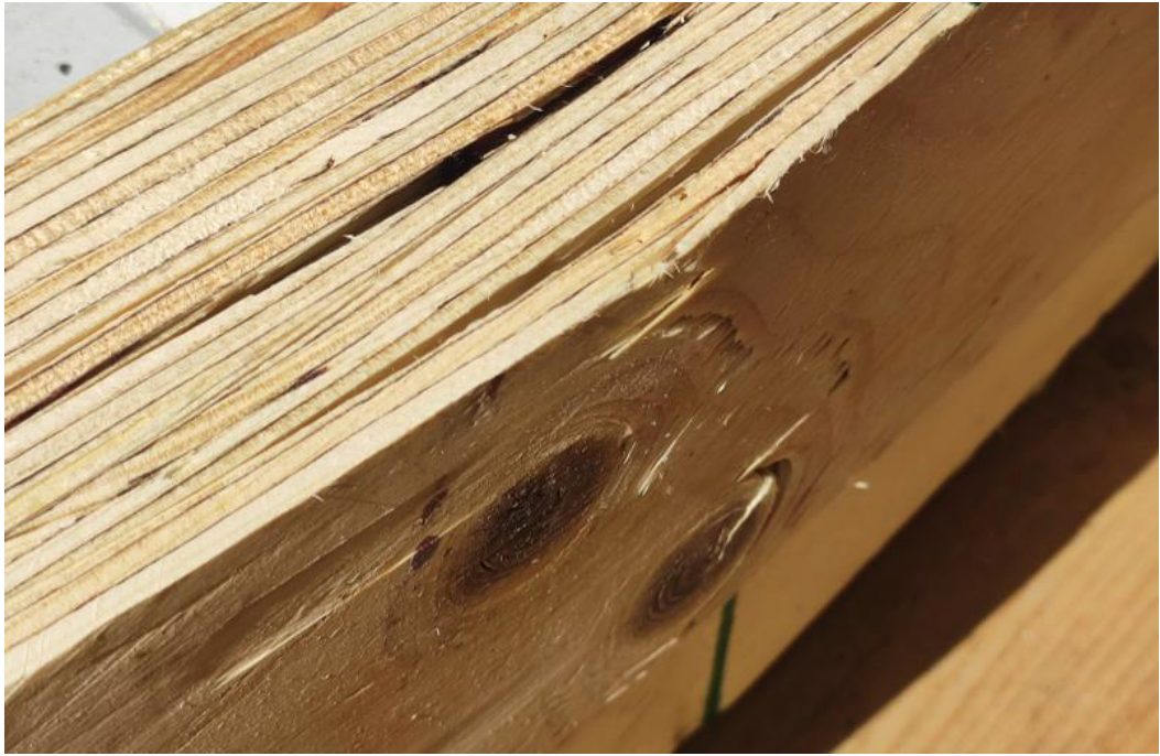
Рисунок 3.34 – Повреждения по материалу поясов (LVL) испытываемых балок – разрушение поясов от нормальных напряжений.
