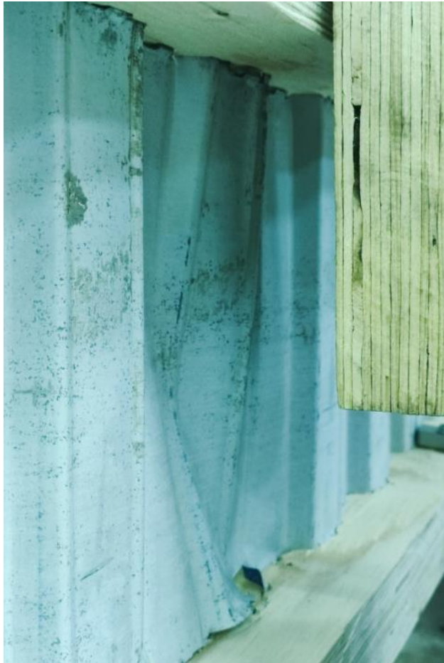
Рисунок 3.36 – Потеря местной устойчивости стенки.
