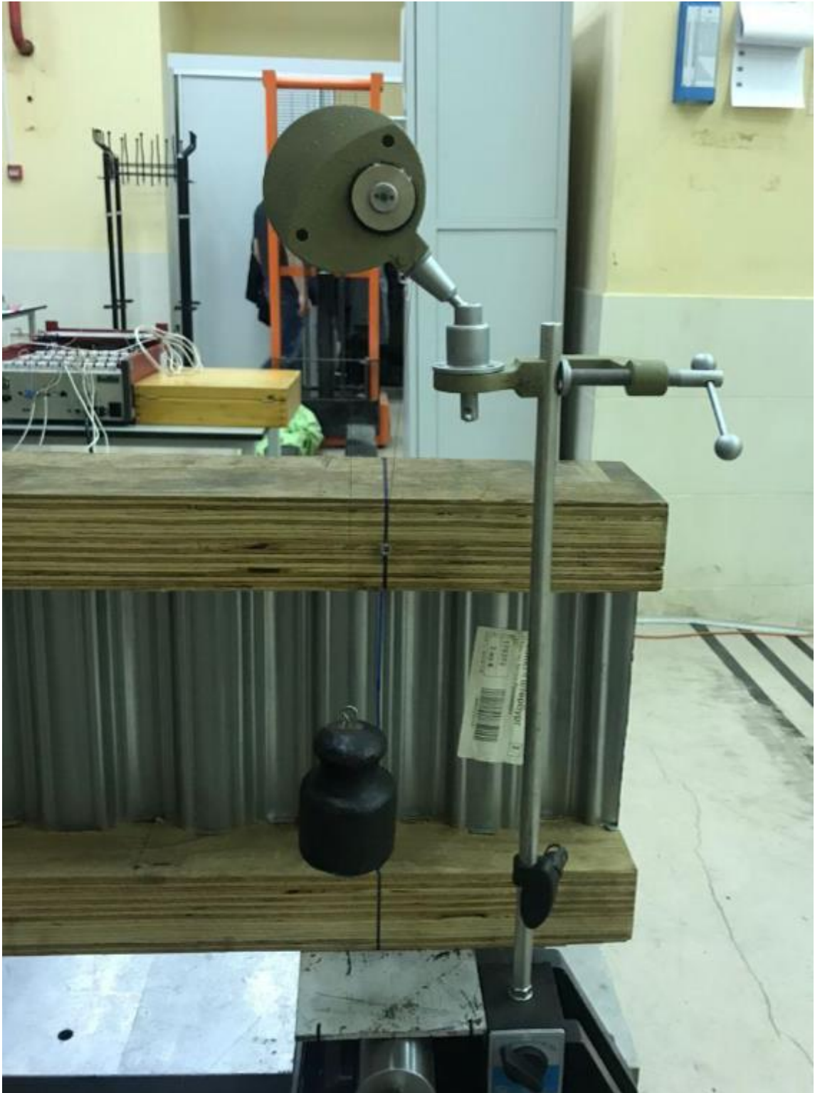
Рисунок 3.11 – Прогибомер для определения величины смятия на опоре.
