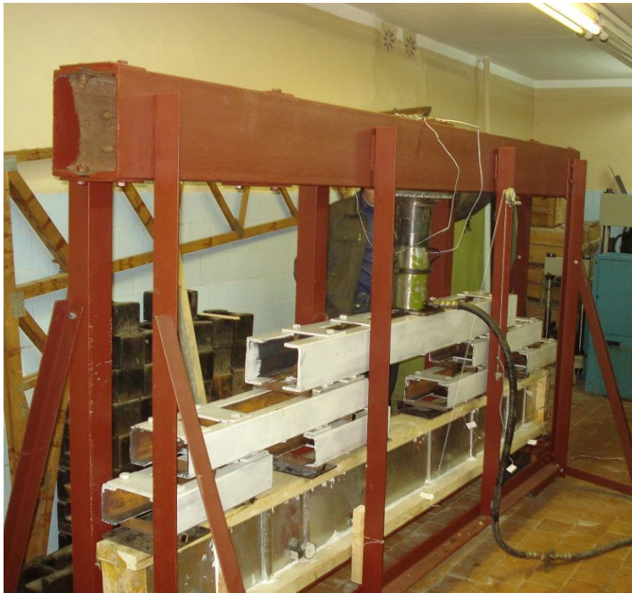
Рисунок 1.13 – Тонкостенная металлодеревянная двутавровая балка с ребрами жесткости в виде полупоцилиндрических гофров (в процессе испытания) [12]
