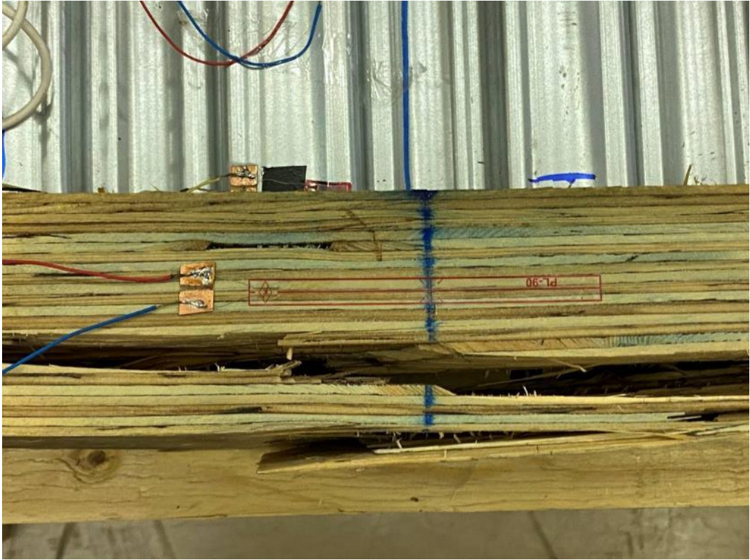
Рисунок 3.16 – Разрыв нижнего пояса.
