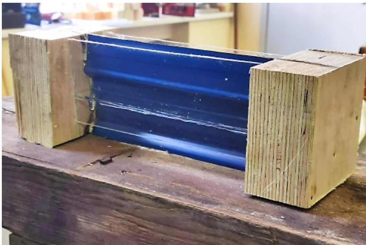
Рисунок 3.2 – Образец для испытания перед замоноличиванием стенки эпоксидным клеем (акриловая опалубка).
