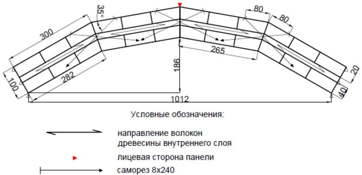
Рисунок 4.7.б) Геометрические параметры образца, вид с лицевой стороны
