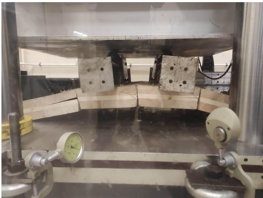
Рисунок 4.13. Разрушение образца в ходе эксперимента
