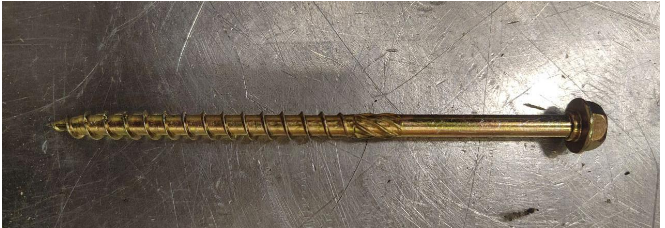
Рисунок 4.18. Используемые при сборке саморезы 8x140 мм
