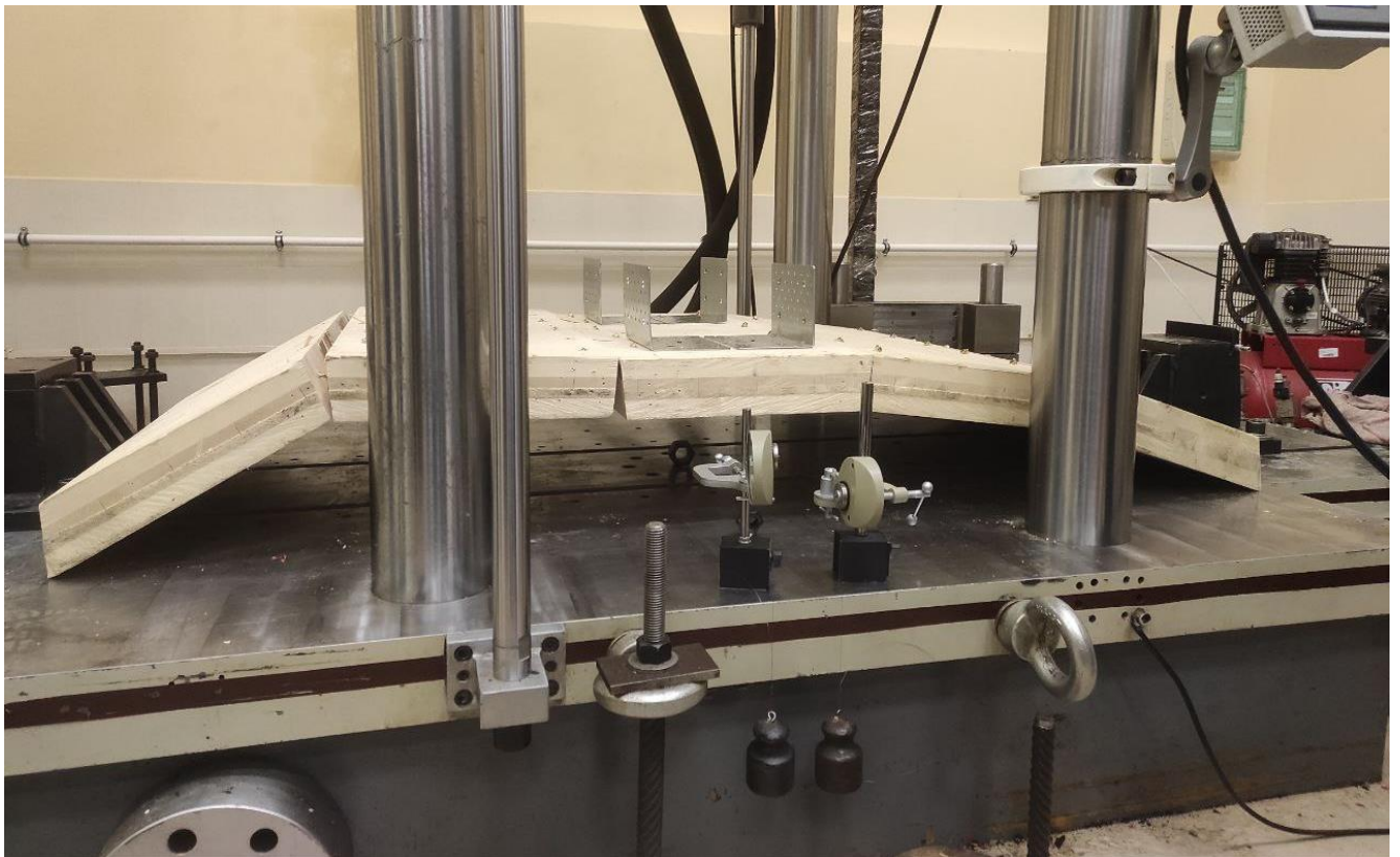
Рисунок 4.28. Состояние конструкции после снятия нагрузки
