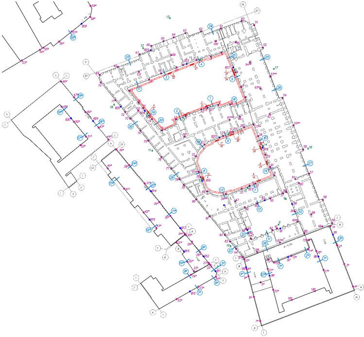
Рисунок 4 –Схема расположения контрольно-измерительного оборудования в границах объекта реконструкции
