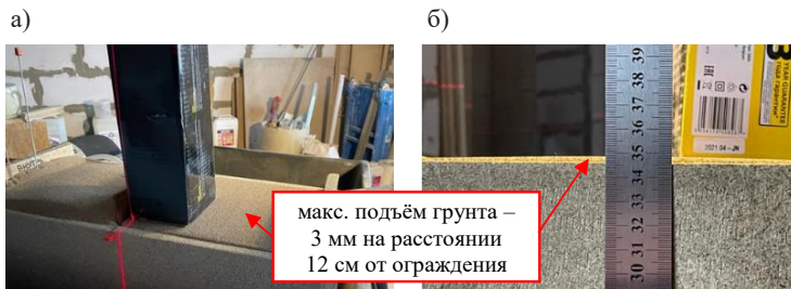
Рисунок 1 а, б – Результаты лабораторного эксперимента – подъём поверхности грунта за ограждением
