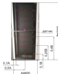
Рисунок 1 – Машинный зал ЦОД в г. Санкт-Петербург: а – план машинного зала: С1-С24 – стойки с серверным оборудованием, К – кондиционеры, К р – резервные кондиционеры; б – «горячий» коридор над которым установлены потолочные панели; в – «холодный» коридор; г – серверное оборудование в стойке; д – расположение точек измерения и датчика температуры воздуха, входящего в стойки
