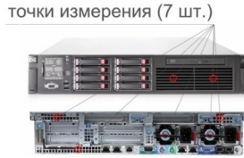
Рисунок 6 – Расположение точек измерения скорости воздуха на серверном оборудовании стойечного типа
