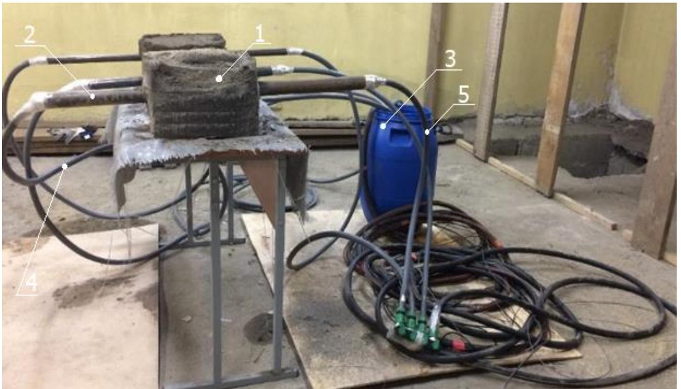
Рисунок 2.19 – Лабораторная экспериментальная установка: 1 – блок мёрзлого грунта из песка; 2 – трубопровод; 3 – бак с погружным насосом; 4 – подающий шланг; 5 – отводящий шланг
