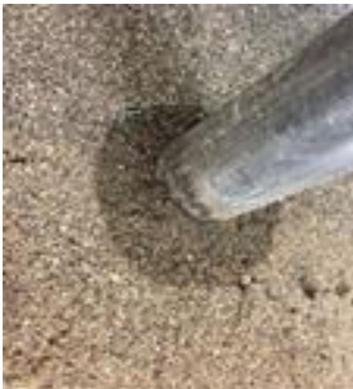
Рисунок 2.22 – Внешний вид талика, полученного на экспериментальной установке
