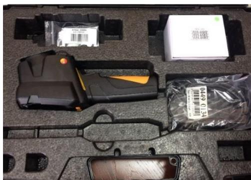
Рисунок 2.3 – Тепловизор *Testo 872*
