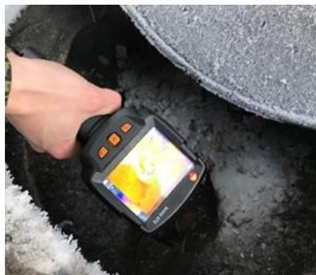
Рисунок 2.9 – Натурное измерение температуры сточной воды в колодце
