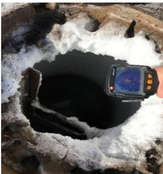
Рисунок 2.4 – Измерения температуры сточной воды в лотке колодца КК1
