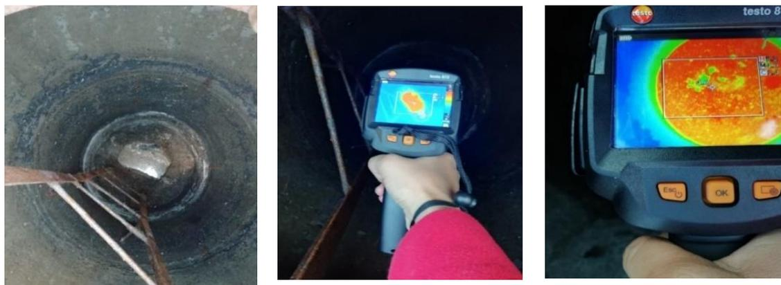
Рисунок 2.16 – Натурные измерения температуры сточной воды в лотке колодцев
