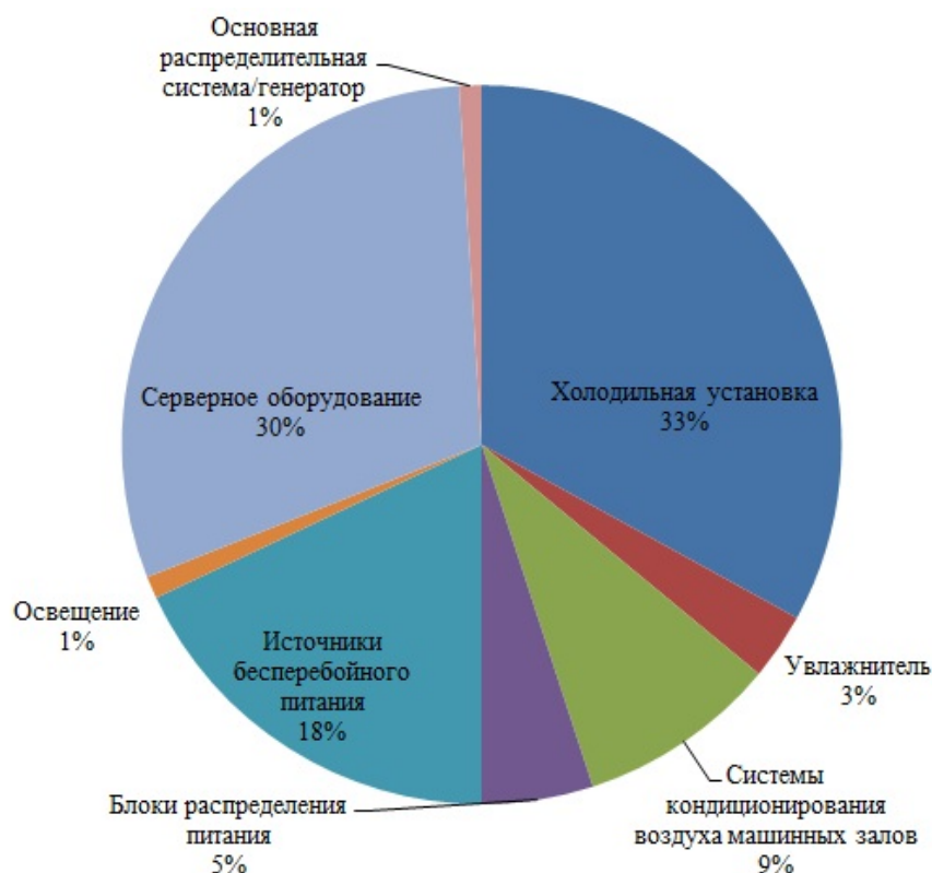
Рисунок 1.10 – Пример распределения электроэнергии в реальном ЦОД [1]
