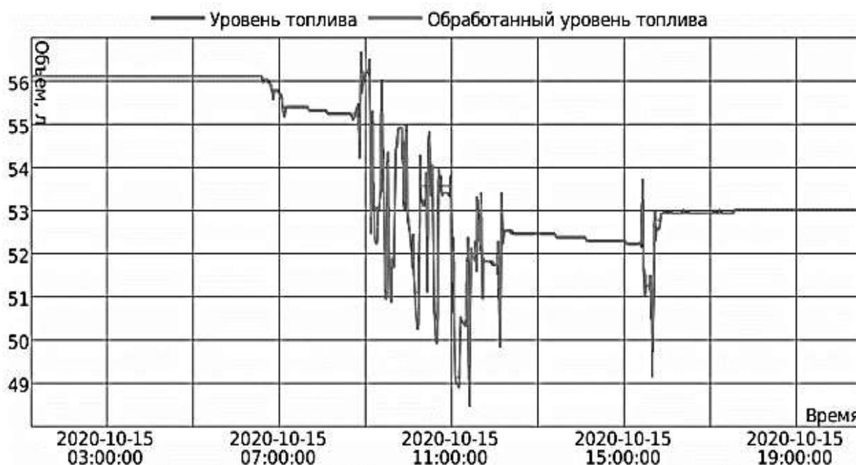
Рисунок 2.7 - Результаты обработки (фильтрации) получаемых от ДУТ данных
