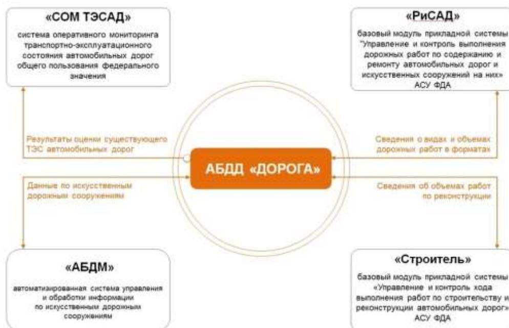
Рисунок 2.1 – Структура информационного взаимодействия АДБД «Дорога» с другими системами
