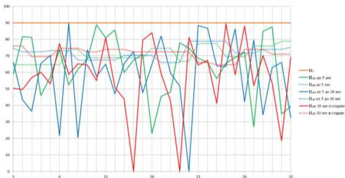
Рисунок 3.3 - График изменения средних значений часовой эксплуатационной расчетной и фактической производительностей трех машин на базе КамАЗ 65115 для содержания дорог по дням в течение июля 2020 г. [41]
