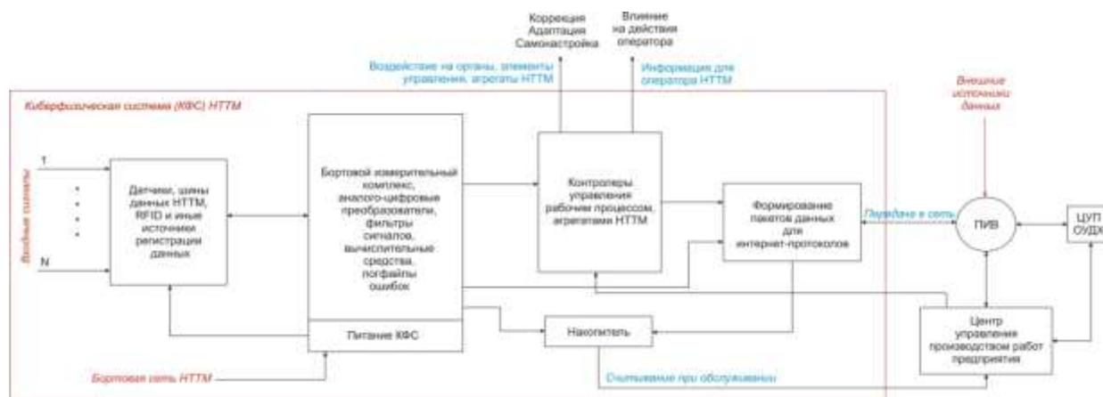
Рисунок 2.14 - Универсальная схема типового подключения БОД получаемых с киберфизических систем (КФС) на НТТМ к ПИВ, реализующая управляющие воздействия на НТТМ для задачи формирования СОЭПЭ НТТМ
