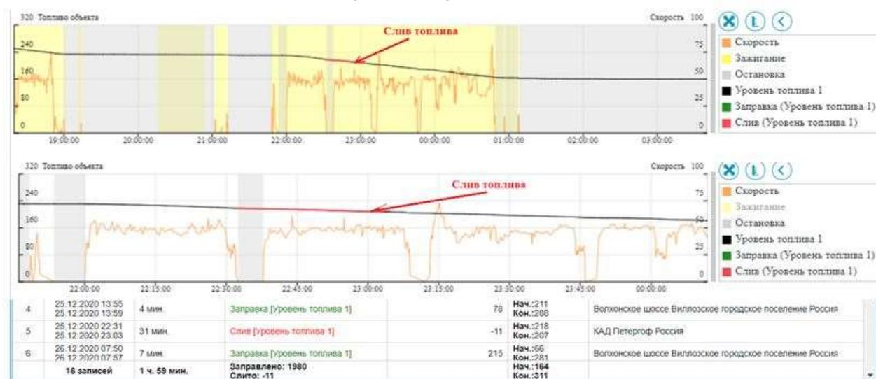
Рисунок 2.10 - Скрин окна системы мониторинга дорожной машины. Слив топлива при работе дорожной машины
