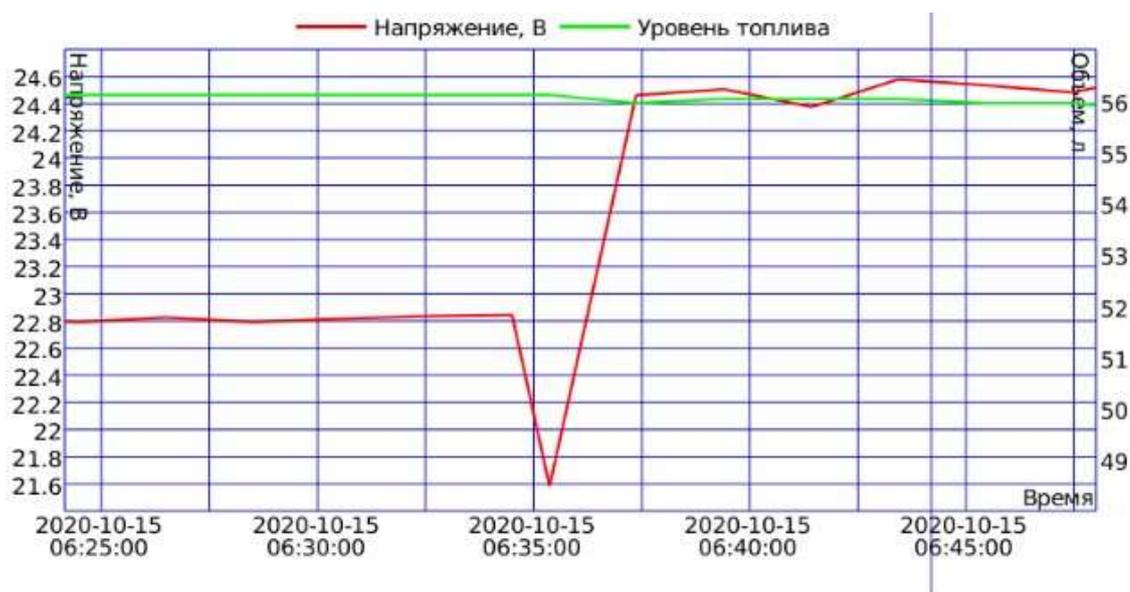
Рисунок 2.11 - Скрин окна системы мониторинга дорожной машины. Трудный запуск двигателя при работе дорожной машины
