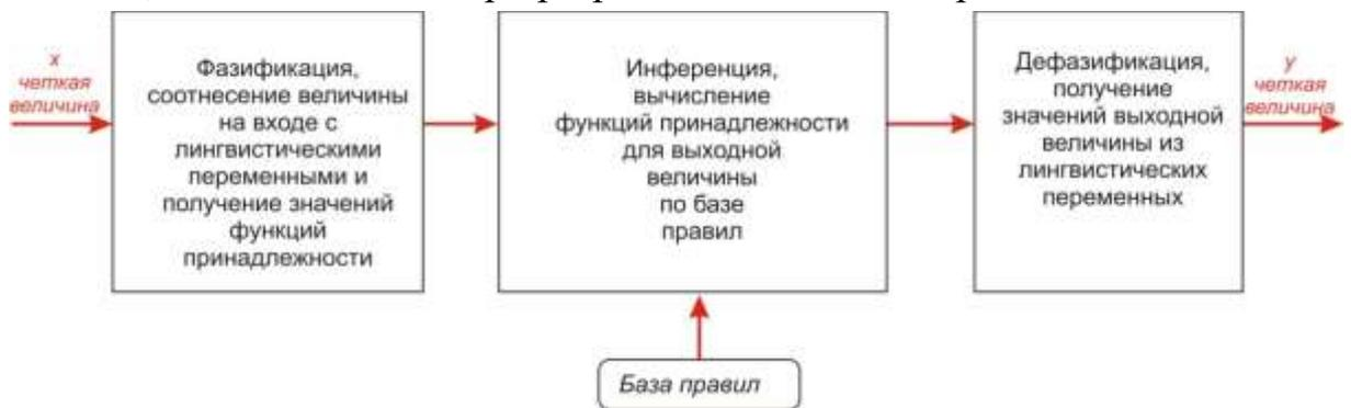
Рисунок 4.13 – Обобщенная схема реализации МНЛ
