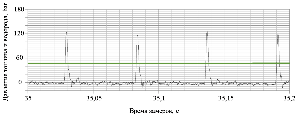
Рисунок 3.12 – Диаграмма впрыска топлива в ДВС специального автотранспорта при давлении подачи водородной примеси 0,45 МПа
