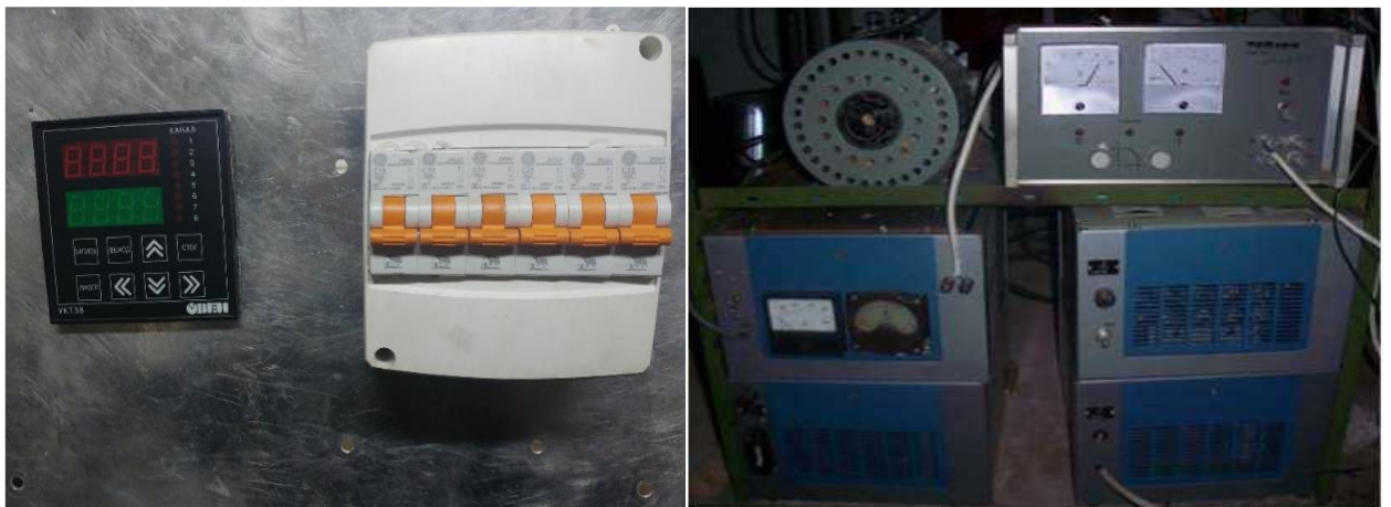
Рисунок 3.2 – Система управления нагрузкой ДВС
