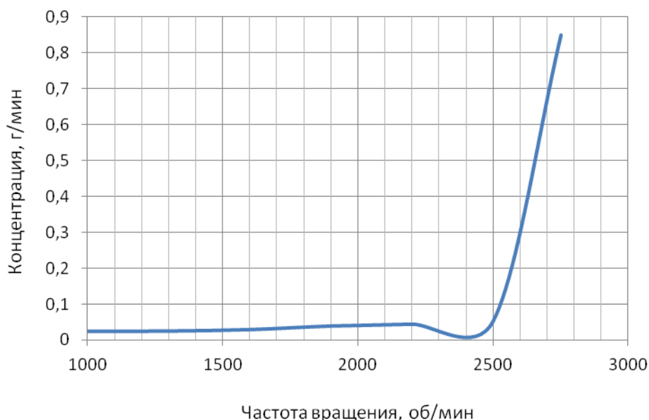
Рисунок 1.16 – Зависимость средних значений выбросов HC для двигателя Tector 4, установленного на автомобиле Iveco EuroCargo, мощностью 160 л.с. в режиме без нагрузки от частоты вращения коленчатого вала
