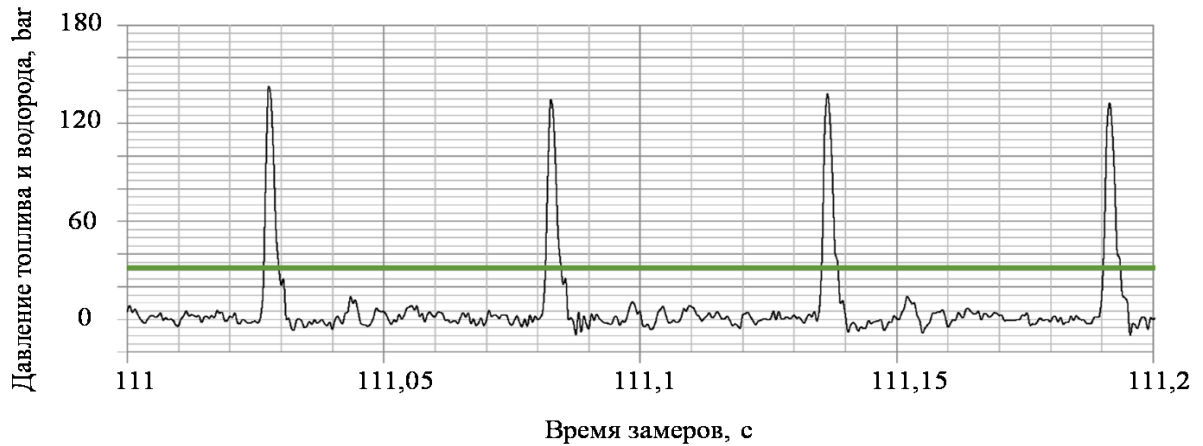
Рисунок 3.11 – Диаграмма впрыска топлива в ДВС специального автотранспорта при давлении подачи водородной примеси 0,3 МПа
