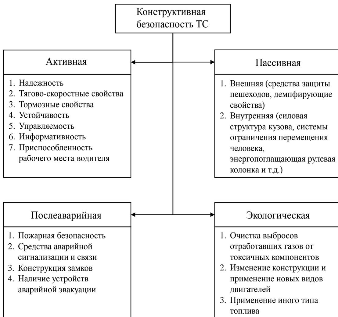
Рисунок 1.12 – Структура конструктивной безопасности ТС
