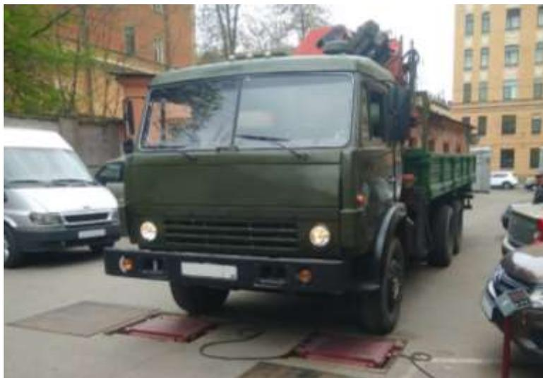
Рисунок 2.2 – Взвешивание ТС с установленным за кабиной КМУ (зафиксировано превышение нагрузки на переднюю ось)
