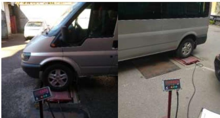
Рисунок 3.2 – Экспериментальное определение осевых нагрузок и нагрузок, действующих на каждое колесо автомобиля Ford Transit
