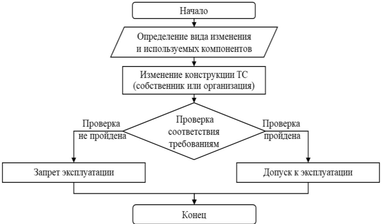
Рисунок 1.17 – Алгоритм допуска к эксплуатации ТС, с внесенными в конструкцию изменениями, в США
