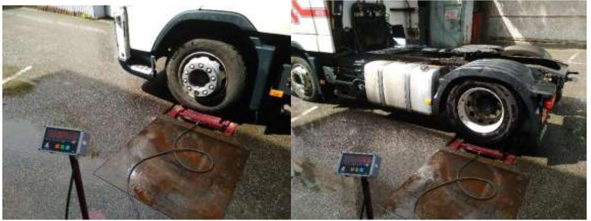
Рисунок 3.3 – Экспериментальное определение осевых нагрузок и нагрузок, действующих на каждое колесо автомобиля Volvo FH
