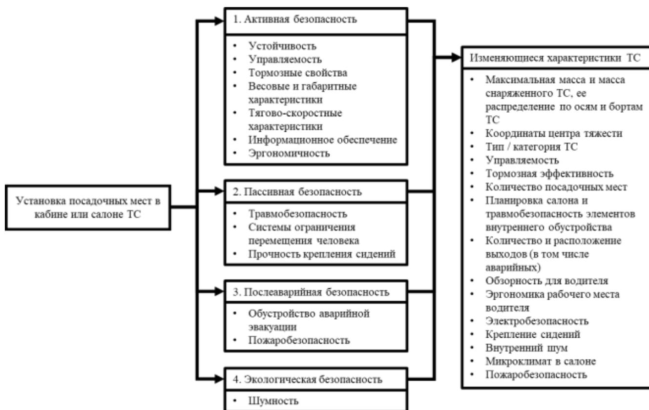
Рисунок 2.1 – Схема определения характеристик ТС, изменяющихся при переоборудовании
