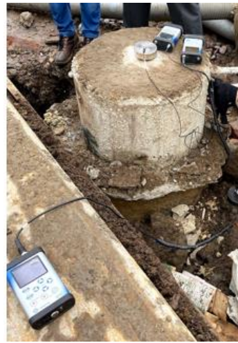
Рисунок 2.20 Используемый вибропогружатель (а); Установка приборов на исследуемую сваю (б).
