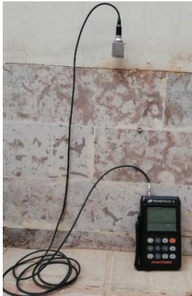
Рисунок 1.10 Используемое оборудование при определении колебаний грунта и конструкций в процессе вибропогружения и виброизвлечения свай
