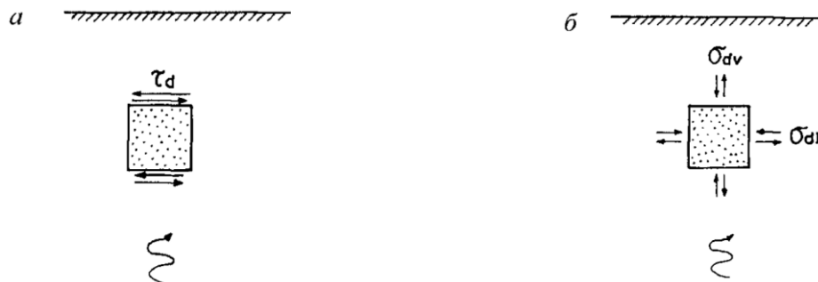
Рисунок 1.9 Динамические напряжения в грунтах при прохождении поперечной волны (а); при прохождении продольной волны (б). Для сейсмического воздействия
