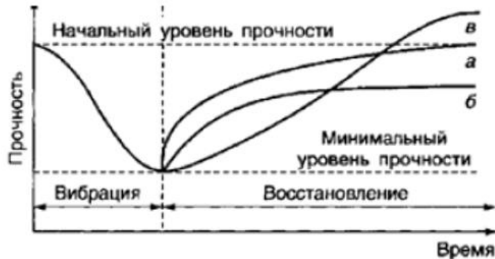
Рисунок 1.15 Изменение прочности тиксотропного (а), квазитиксотропного (б,в) грунта
