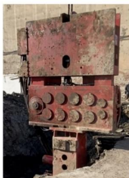
Рисунок 2.12 Используемый вибропогружатель PVE40VM на первой опытной площадке.
