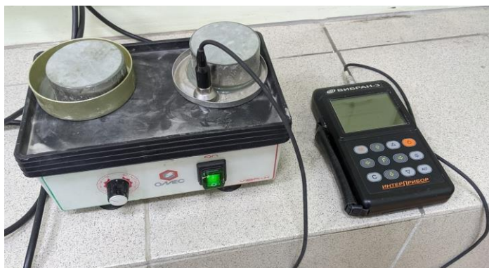
Рисунок 3.1 Вибрирование образцов глинистого грунта перед испытанием одноплоскостным срезом
