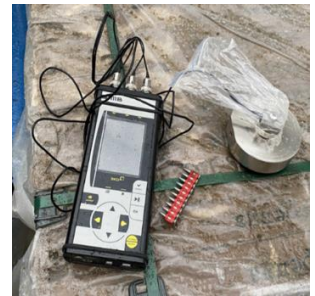
Рисунок 1.10 Используемое оборудование при определении колебаний грунта и конструкций в процессе вибропогружения и виброизвлечения свай
