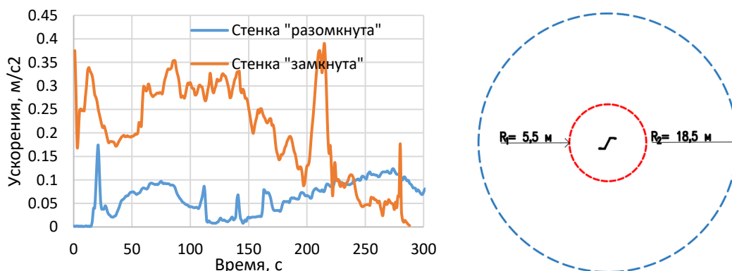
Рисунок 2.33 Сопоставление осциллограмм ускорений колебаний фундамента при замкнутой и разомкнутой стенке (слева); сопоставление изменения зоны влияния (справа).
