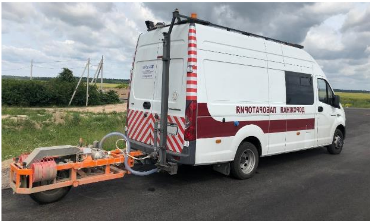
Рисунок 1.7 - Дорожная лаборатория КП-514 РДТ на базе «Газель» NEXТ с динамометрическим прицепом типа ПКРС-2 РДТ
