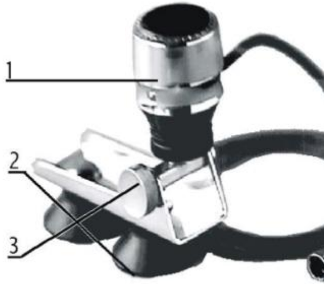
Рисунок 3.11 – Датчик деселерометра модели «LWS-2MC», где 1 - датчик ускорения; 2 – основание датчика; 3 – шарнирный механизм.
