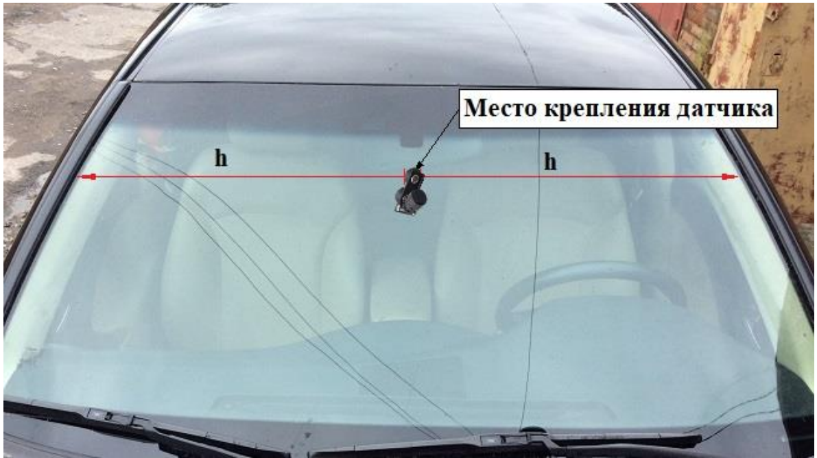
Рисунок 3.13 – Схема крепления датчика на лобовое стекло ТС внутри салона
