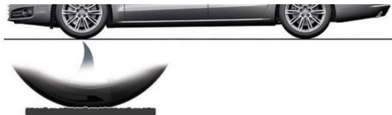
Рисунок 1.13 - Пятно контакта протектора шины с дорожным покрытием
