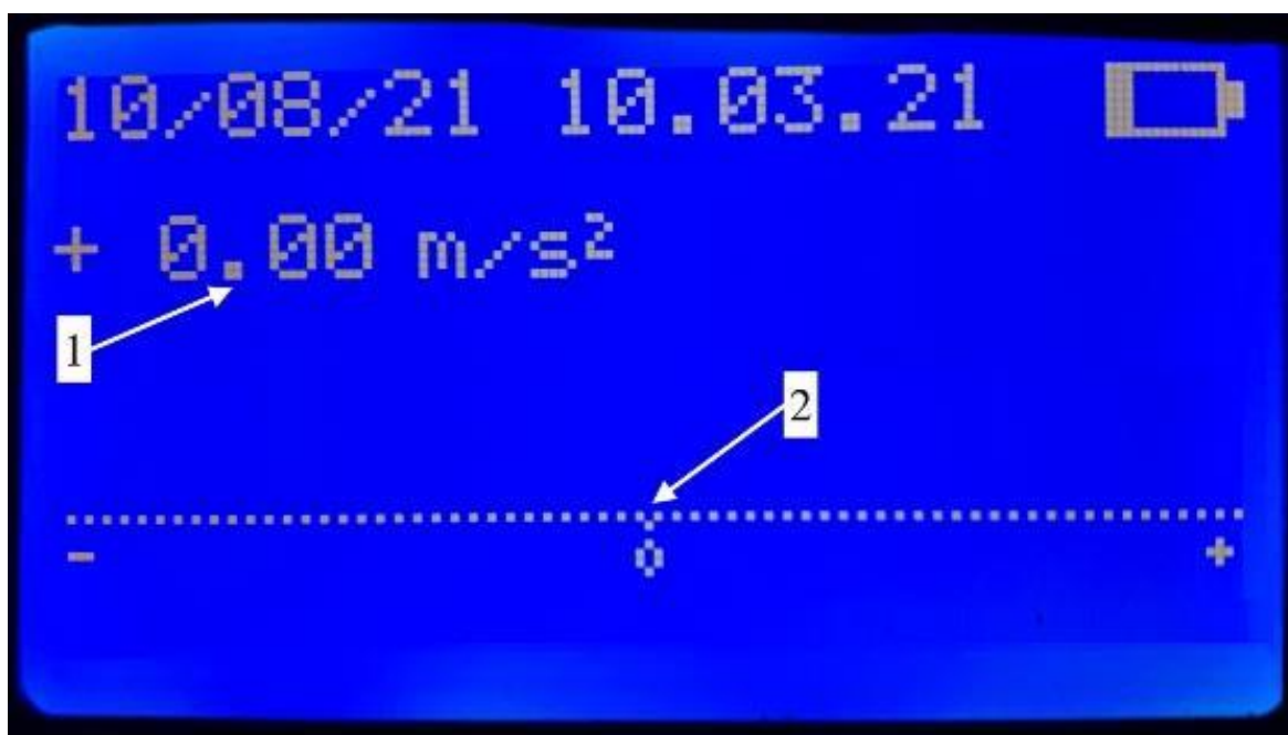
Рисунок 3.15 – Меню калибровки датчика ускорения, где 1 – цифровое обозначение значения ускорения, 2 – графическое отображение ускорения
