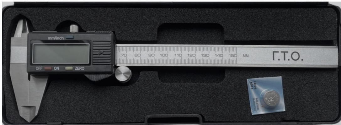
Рисунок 3.14 – Электронный штангенциркуль с глубиномером ГТО ШЦЦ-I-150
