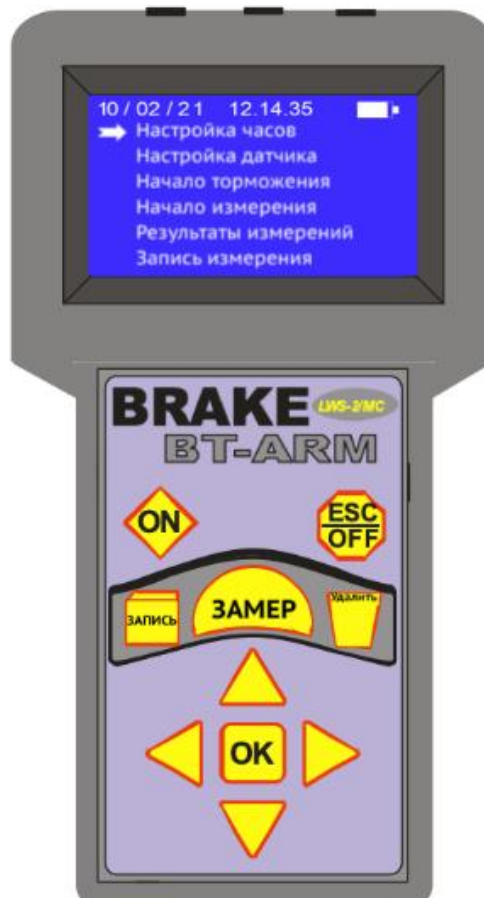
Рисунок 3.12 – Деселерометр модели «LWS-2MC»
