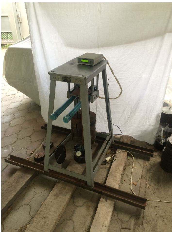
Рисунок 2.9 – Схема (а) и общий вид установки (б) для нагружения модели сваи
