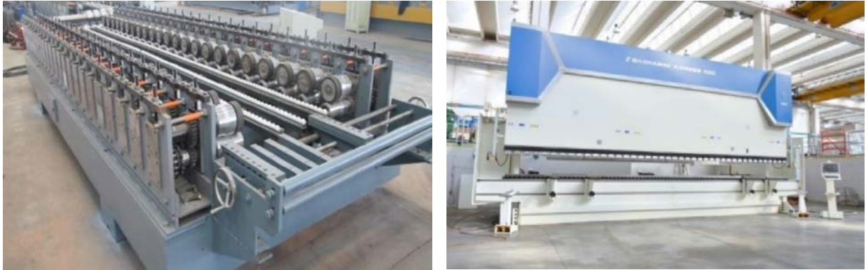
Рис. 1.2. а) профилегибочный стан; б) листогибочный пресс [99]
