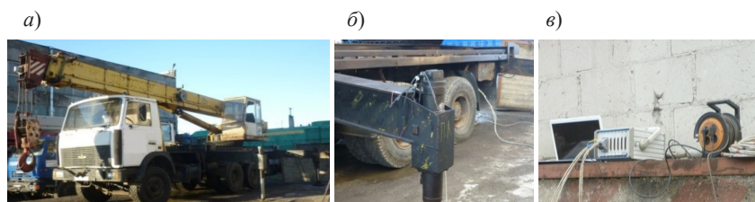
Рисунок 5 – Проведение эксперимента: а – Грузоподъемный кран типа КС-45717; б – размещение тензорезисторов на опоре; в – измерительная и регистрирующая аппаратура
