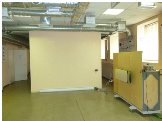
Рисунок 1 – Экспериментальный стенд для исследования системы водяного плинтусного отопления: (а) – схема стенда: 1 – электрокотел «Северянин 9»; 2 – группа безопасности котла; 3 – кран шаровой; 4 – фильтр водяной; 5 – насос циркуляционный; 6 – ультразвуковой датчик расхода теплосчетчика «Multical UF» Dy20; 7 – температурный датчик теплосчетчика; 8 – балансировочный клапан; 9 – испытываемый отопительный прибор; 10 – расширительный бак Reflex; 11 – обратный клапан; (б) – вид стенда; (в) – плинтусный отопительный прибор конвекторного типа
