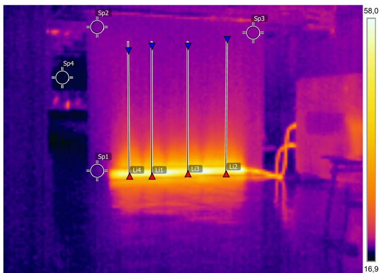
Рисунок 2 – Тепловизионный снимок системы водяного плинтусного отопления
