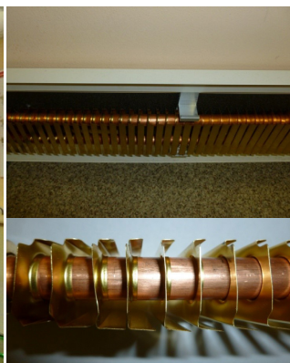
Рисунок 1 – Экспериментальный стенд для исследования системы водяного плинтусного отопления: (а) – схема стенда: 1 – электрокотел «Северянин 9»; 2 – группа безопасности котла; 3 – кран шаровой; 4 – фильтр водяной; 5 – насос циркуляционный; 6 – ультразвуковой датчик расхода теплосчетчика «Multical UF» Dy20; 7 – температурный датчик теплосчетчика; 8 – балансировочный клапан; 9 – испытываемый отопительный прибор; 10 – расширительный бак Reflex; 11 – обратный клапан; (б) – вид стенда; (в) – плинтусный отопительный прибор конвекторного типа
