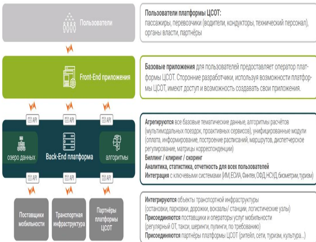
Рисунок 2.4 - Технологическая архитектура Цифровой платформы
