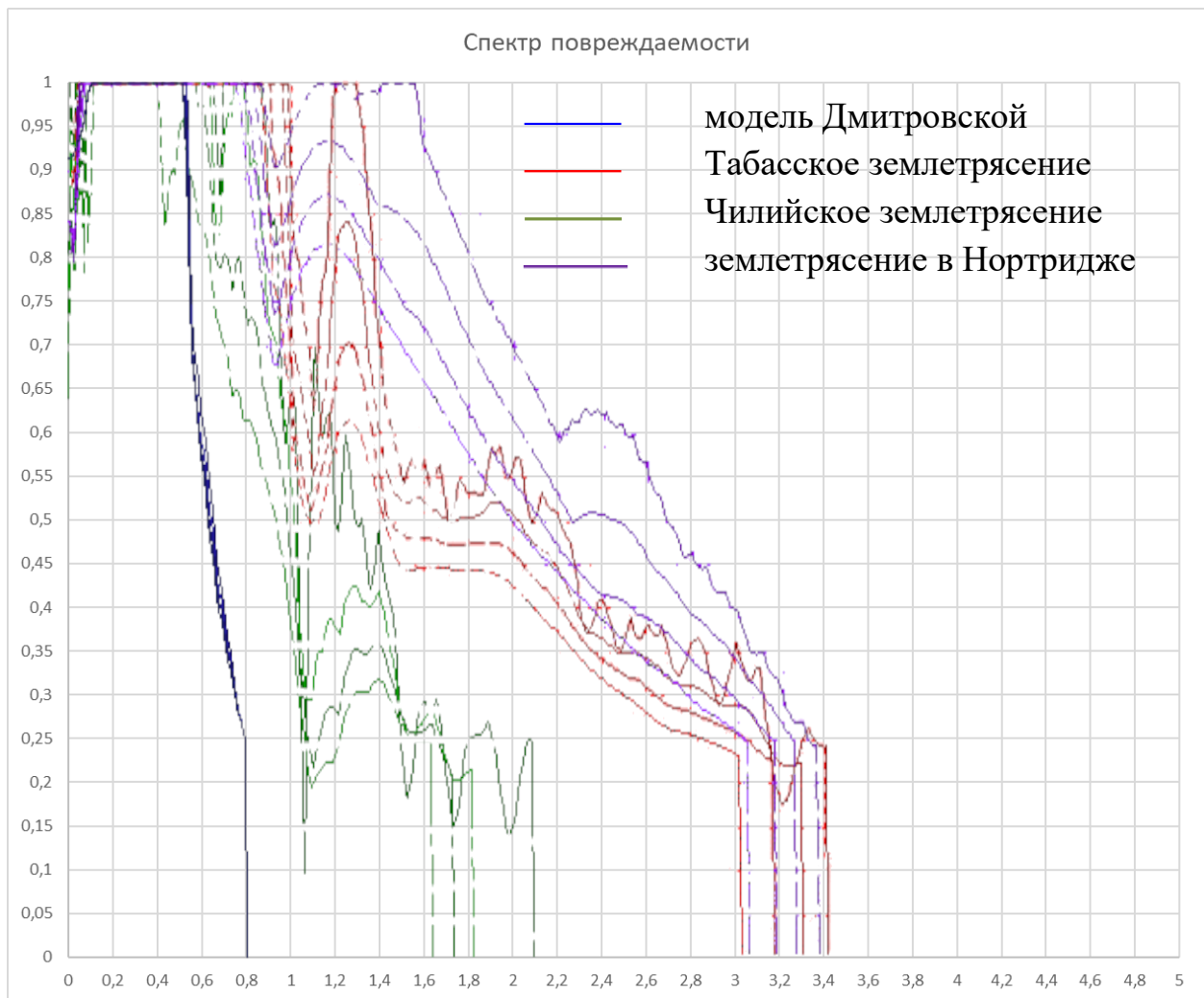
Рисунок 4.18 — Сопоставление спектров повреждаемости сгенерированного воздействия и реальных землетрясений
