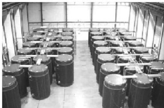
Рисунок 1.5 – Контейнерное хранилище на открытой площадке [74] и в здании [21]
