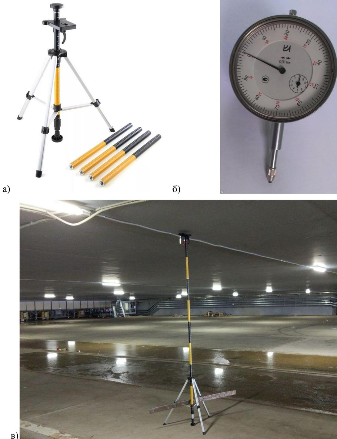
Рисунок 4.11 – Измерение статического прогиба большепролетного сооружения:
