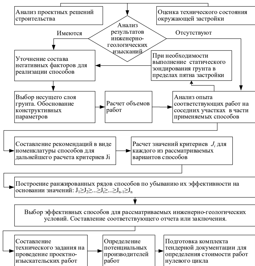
Рисунок 12 – Алгоритм реализации разработанной методологии обоснования эффективных способов производства специальных работ в грунтах по критерию технологичности
