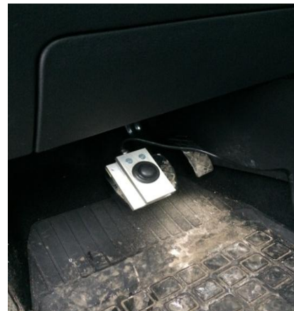
Рисунок 3.8 - Установка датчика на педали тормоза
