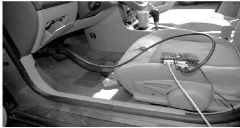
Рисунок 1.18 – Подключение устройства CDR к АТС [124]
