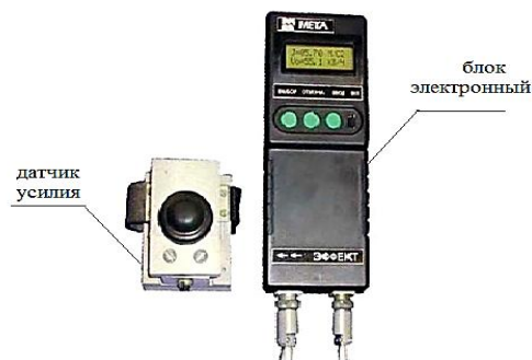
Рис. 3.5 - Внешний вид контрольно-измерительного прибора «Эффект-02»
