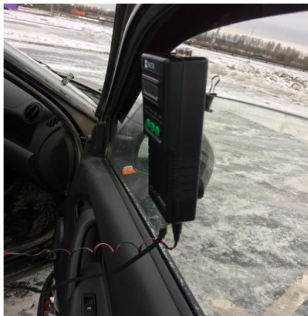
Рисунок 3.7 - Установка блока на боковом ветровом стекле
