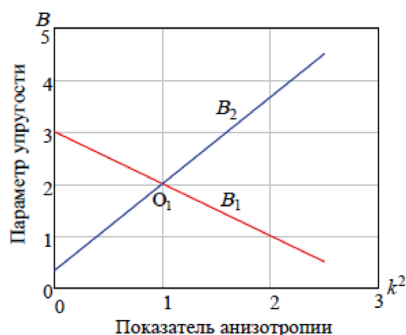
Рис. 8. Взаимосвязь показателя анизотропии от параметров упругости ортотропного тела
