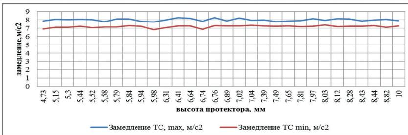
Рисунок 15 – Изменение замедления ТС категории  $M_1$  в зависимости от высоты протектора на зимней резине при нулевой температуре и влажном асфальте
