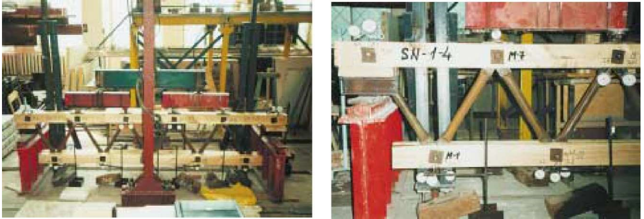
Рисунок 1.14. Экспериментальное исследование фермы с параллельными поясами с когтевыми шайбами Технологическом университете Вильнюса [149].
