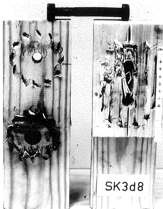
Рисунок 1.12. Типичная картина разрушения образца при испытаниях [117].
