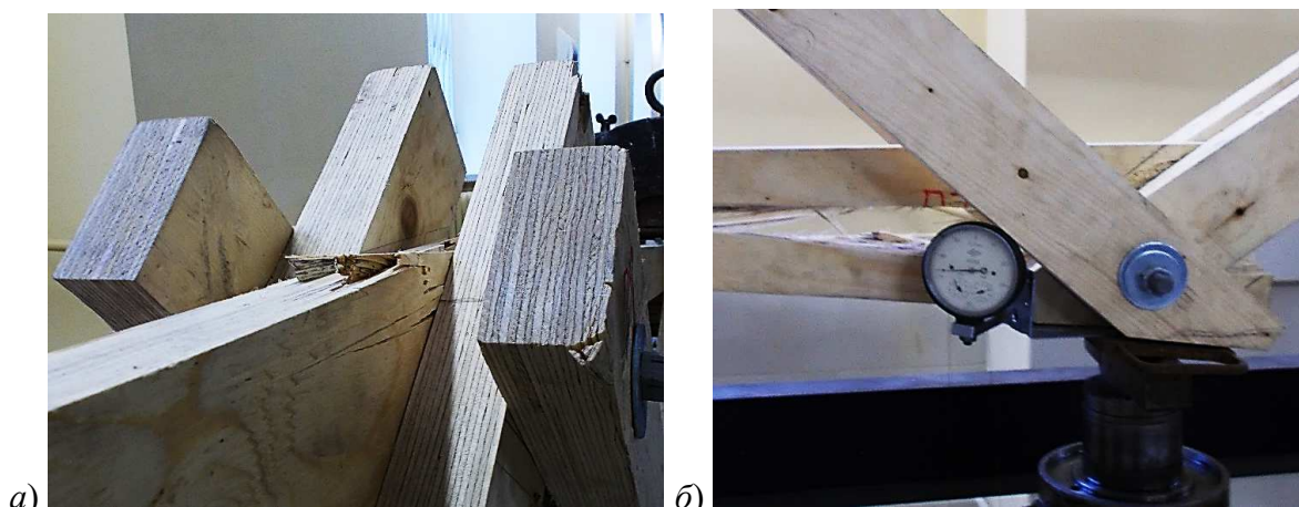
Рисунок 14 – Узлы разрушенной конструкции фермы: а) растянутый пояс б) сжатый пояс
