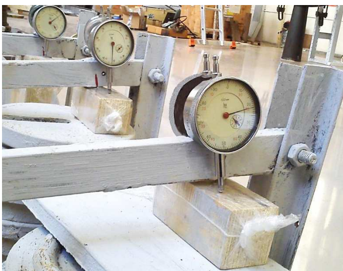
Рисунок 3 – Проведение испытаний для определения сопротивления LVL длительному действию нагрузки треугольным и цилиндрическим штампом
