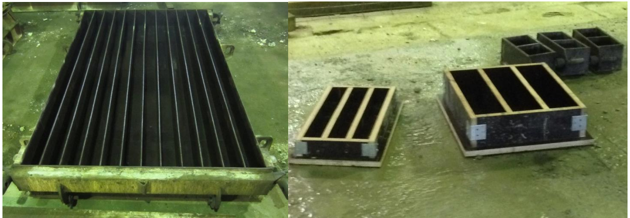
Рисунок 2.4 – Общий вид опалубки и форм для изготовления экспериментальных образцов
