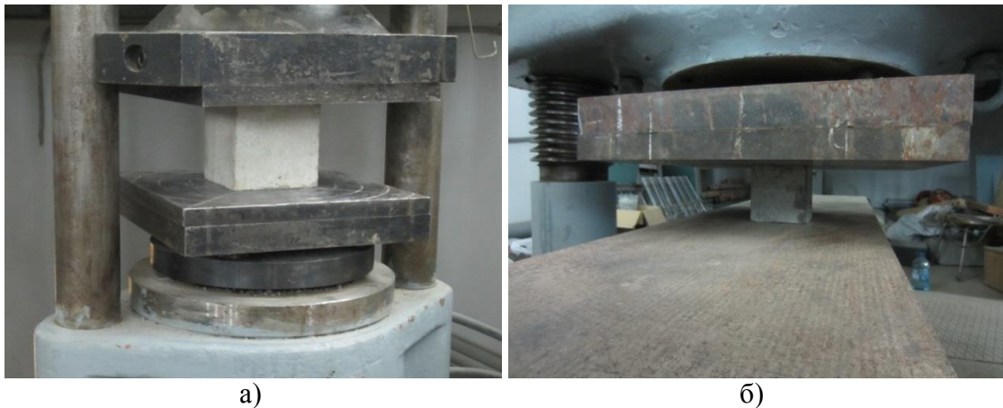
Рисунок 2.6 – Общий вид бетонных (а) и фибробетонных (б) образцов-кубов в процессе испытания на сжатие
