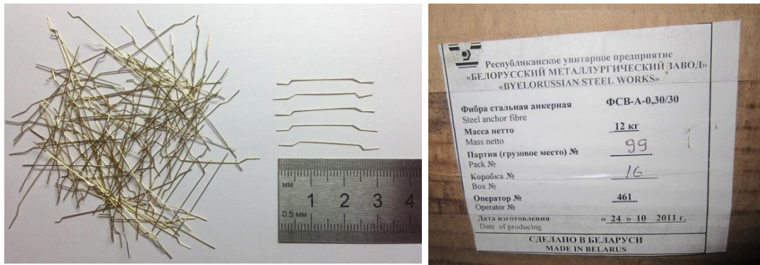
Рисунок 2.1 – Общий вид фибры ФСВ-А-0,30/30 производства ОАО «БМЗ»
