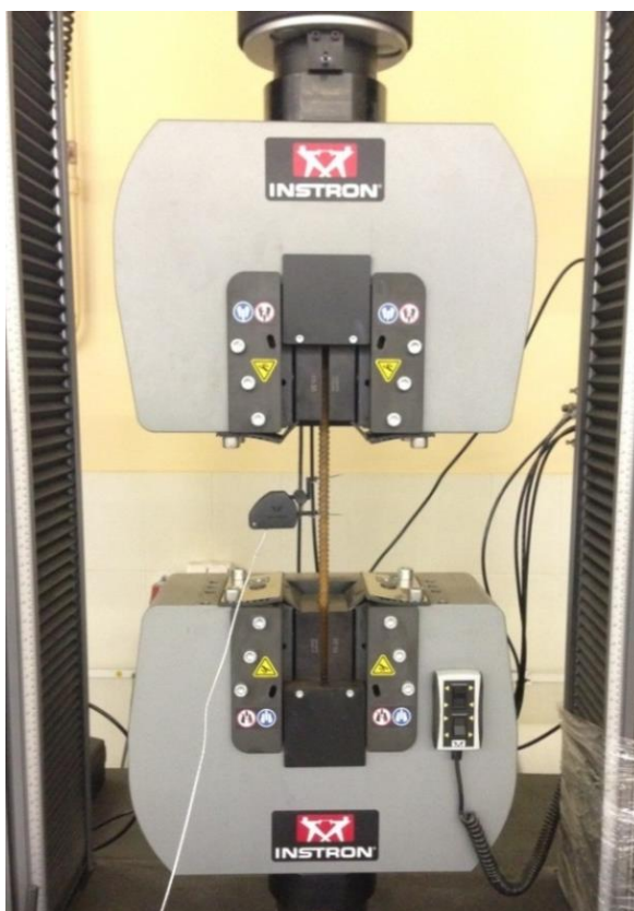
Рисунок 2.16 – Общий вид образца арматуры Ø14 класса At800 в универсальной испытательной системе INSTRON 5989
