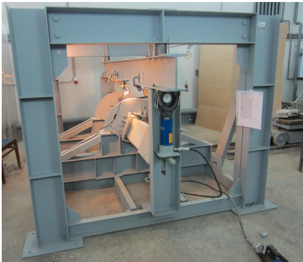
Рисунок 2.22 – Общий вид образца-балки в процессе испытания с торца
