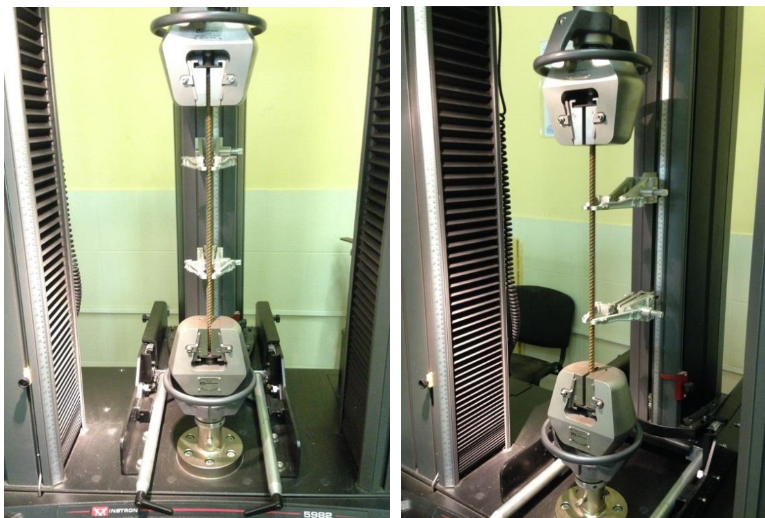
Рисунок 2.15 – Общий вид образца арматуры Ø10 класса A500C в универсальной испытательной системе INSTRON 5982
