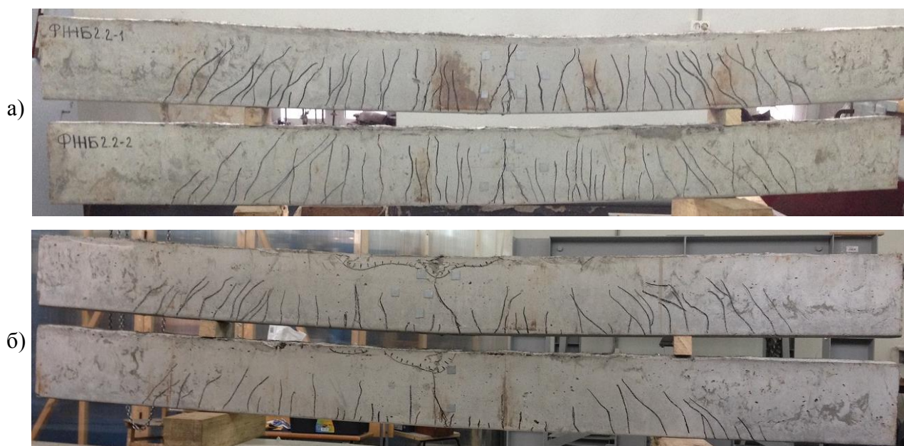
Рисунок 2.36 – Разрушение образцов-балок серий ФЖБ2.2: а) грань А, б) грань Б
