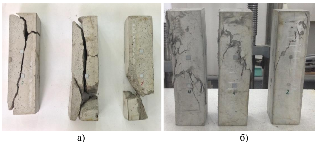
Рисунок 2.9 – Общий вид бетонных (а) и фибробетонных (б) образцов-призм после разрушения
