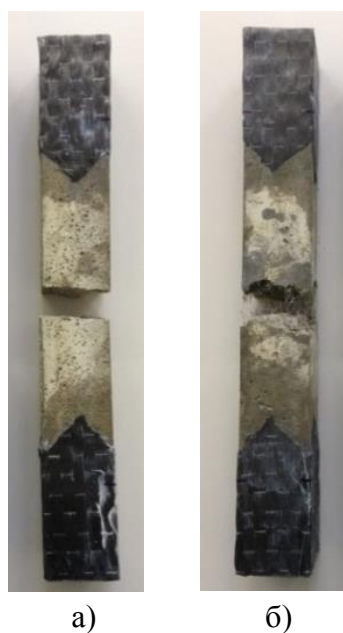
Рисунок 2.11 – Общий вид характерного разрушения бетонных (а) и фибробетонных (б) образцов-призм, испытанных на осевое растяжение
