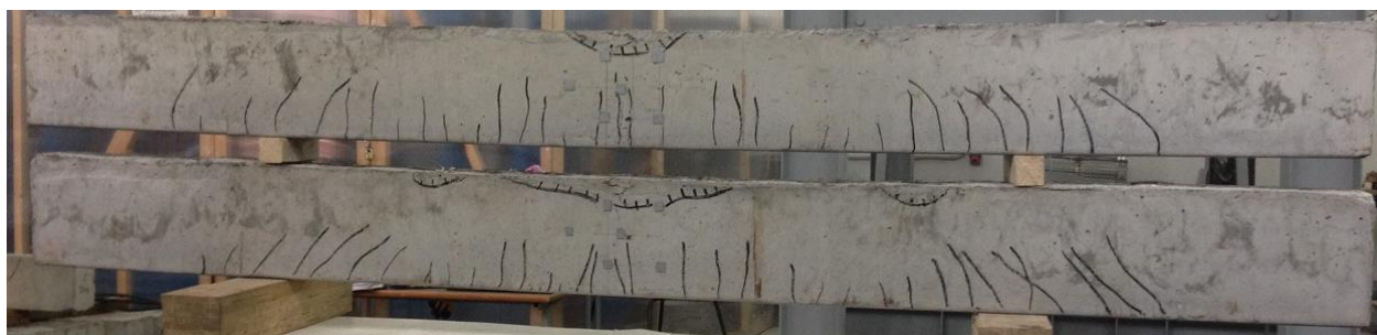
Рисунок 2.34 – Разрушение образцов-балок серий ЖБ1: а) грань А, б) грань Б; ЖБ2: в) грань А, г) грань Б; ФЖБ1.1: д) грань А, е) грань Б
