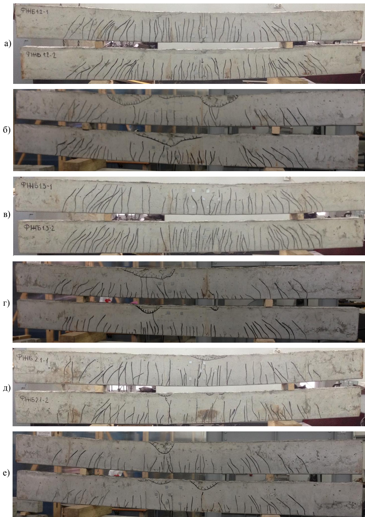
Рисунок 2.35 – Разрушение образцов-балок серий ФЖБ1.2: а) грань А, б) грань Б; ФЖБ1.3: в) грань А, г) грань Б; ФЖБ2.1: д) грань А, е) грань Б
