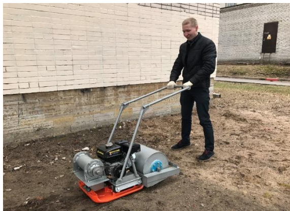
Рисунок 12 – Комбинированный поверхностный вибрационный уплотнитель, управляемый оператором
