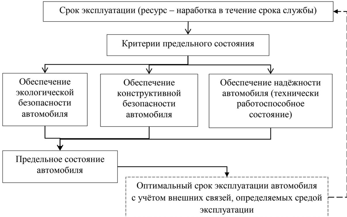
Рисунок 1.9 - Схема связей между понятиями, определяющими срок эксплуатации автомобиля
