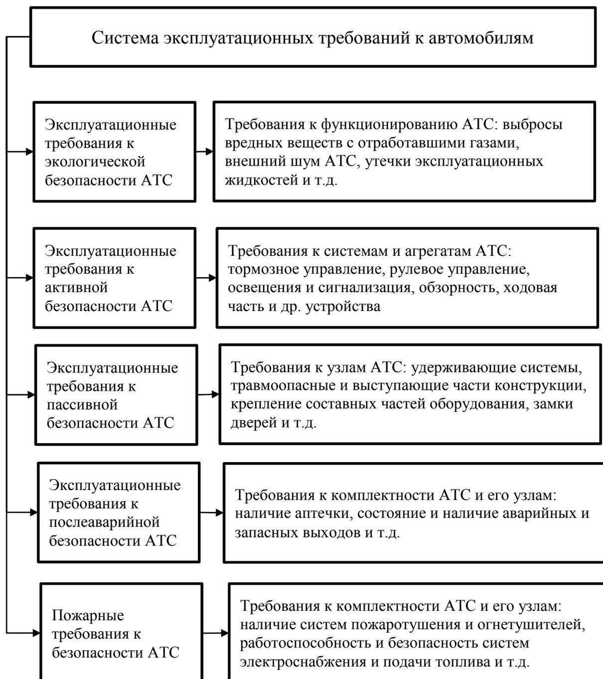
Рисунок - 1.7 Классификация требований к безопасности автомобилей в эксплуатации по отношению к эксплуатационным свойствам автомобиля
