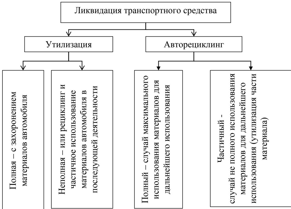
Рисунок 1.11 - Структурная схема процесса ликвидации автомобиля
