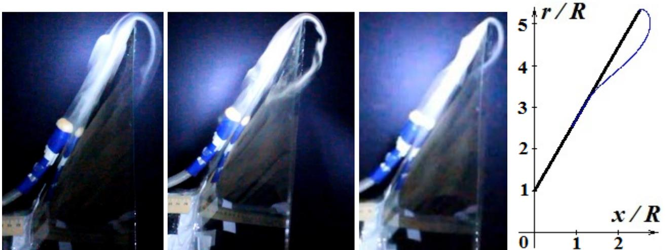
Рисунок 4.11 – Отрывная область на входе в раструб 5 калибров с углом наклона  $60^\circ$ : а)  $b = 0.7$ ,  $a_0 = 0.063$ ,  $l = 0.80$ ,  $r_e = 3.29$ ; б)  $b = 0.8$ ,  $a_0 = 0.071$ ,  $l = 0.98$ ,  $a = 2.55$ ;  $r_e = 3.8$ ; в)  $b = 0.51$ ,  $a_0 = 0.064$ ,  $l = 0.44$ ,  $a = 1.95$ ;  $r_e = 3.96$ ; г)  $b = 0.47$ ,  $a_0 = 0.052$ ,  $l = 0.58$ ,  $a = 2.91$ ;  $r_e = 4.43$
