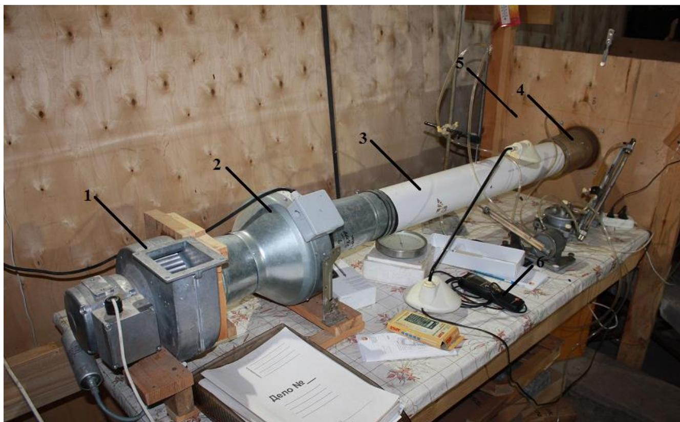
а) первая часть экспериментальной установки: 1 – вентилятор ЕХ-18 4с Systemair; 2 – вентилятор ВКМц 150 Вентс; 3 – пластиковый воздуховод; 4 – коллектор; 5 – деревянный щит; 6 - термоанемометром testo-435
