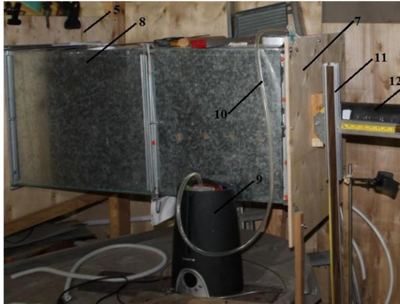
б) вторая часть экспериментальной установки: 5, 7 – деревянные щиты; 8 – камера статического давления; 9 – увлажнитель воздуха Polaris; 10 – пластиковая трубка; 11 – штатив; 12 – пластиковая труба
