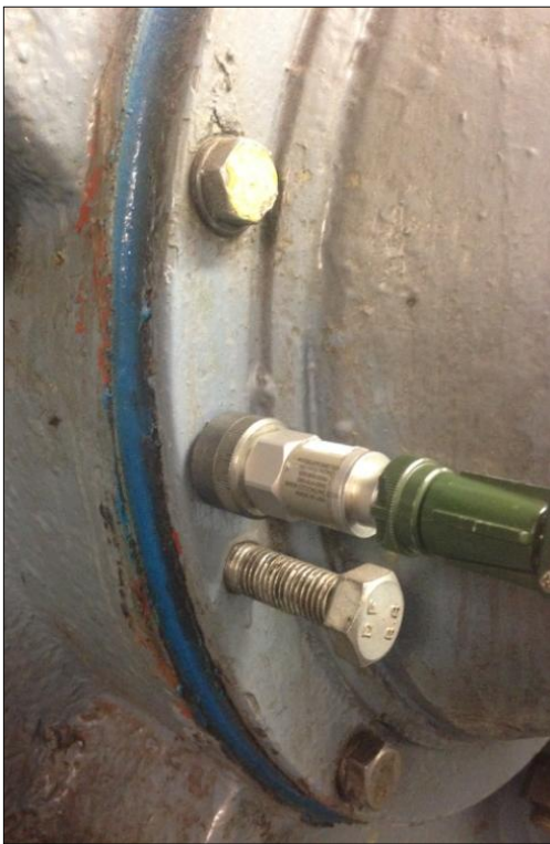
Рис. 3.8. Установка датчика с помощью постоянного магнита
