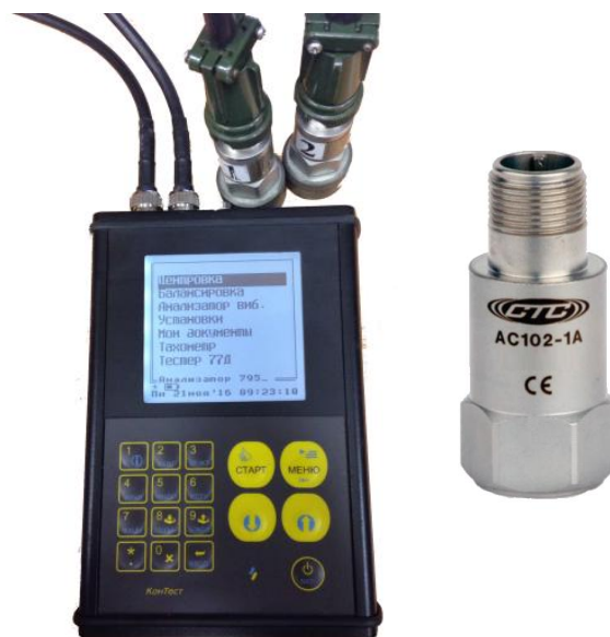
Рис. 3.1. Виброанализатор КОН.ТЕСТ С9000 с датчиками вибрации СТС АС102-1А
