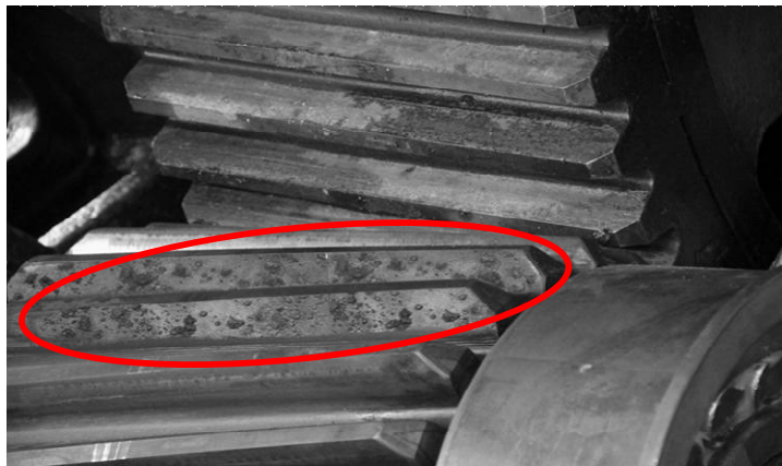
Рис. 3.22. Питтинг зубьев шестерни тихоходного вала редуктора эскалатора ЭТ-2
