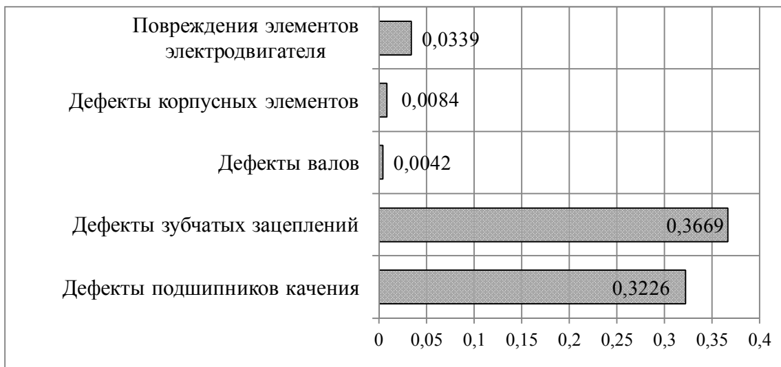
Рисунок 1.15. Интенсивность дефектов основных элементов привода, 1/год
