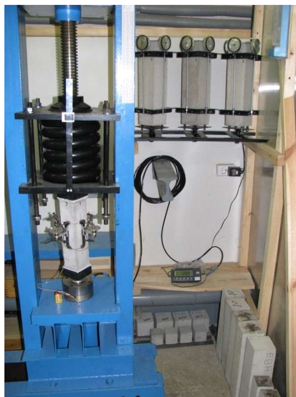
Рис. 2. Испытание образцов на ползучесть и контроль нагрузки с помощью динамометра
