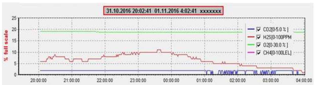
Рисунок 3.13 – Концентрация углекислого газа, метана, кислорода и сероводорода в шахте 350Б в октябре 2016 г.
