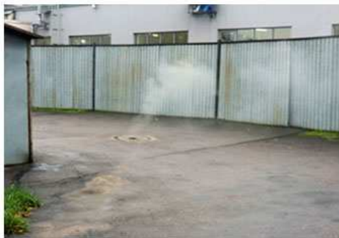
Рисунок. 1.5 – Выброс газообразного вещества, насыщенного агрессивными газами, на дневную поверхность земли в Санкт-Петербурге
