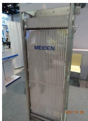
Рисунок 4.2 – Керамические плоские мембраны фирмы MEIDEN
