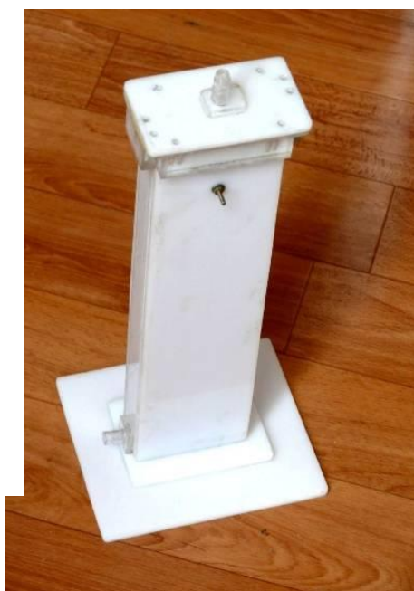
Рисунок 5.1 – Внешний вид (слева) и схема (справа) экспериментального макета установки обеззараживания сточных вод 1 – корпус; 2 - входной патрубок; 3 – электроды; 4 – загрузка; 5 - выходной патрубок
