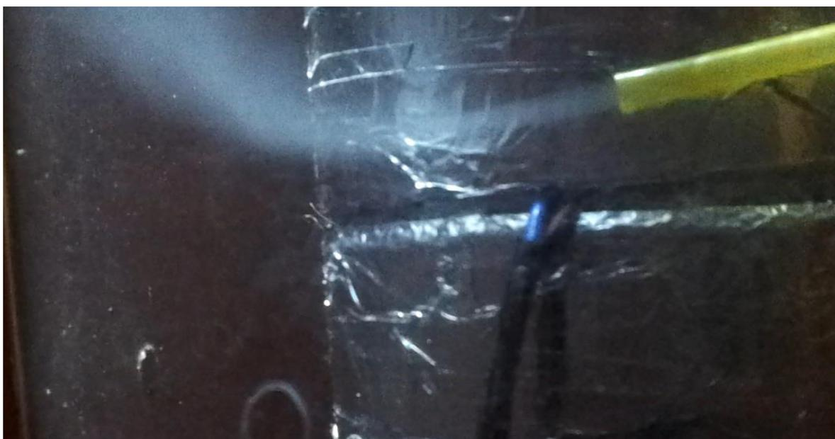
Рисунок 3.6 – Движение дыма при совместной работе вентиляторов
