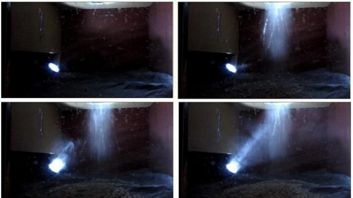
Рисунок 3.18 – Образование вихрей запыленного воздуха в приемной камере
