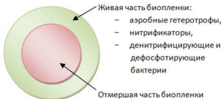
Рисунок 2.12 - Структура аэробного гранулированного ила, полученного в результате эксплуатации реактора в циклическом режиме с восходящим потоком сточной воды с последовательной нитри-денитрификацией
