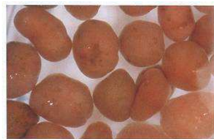
Рисунок 1.18 - Гранулы, образованные в ходе процесса Анаммох (диаметр около 1 мм) в одnoreакторной системе в ходе исследований в г. Olburgen
