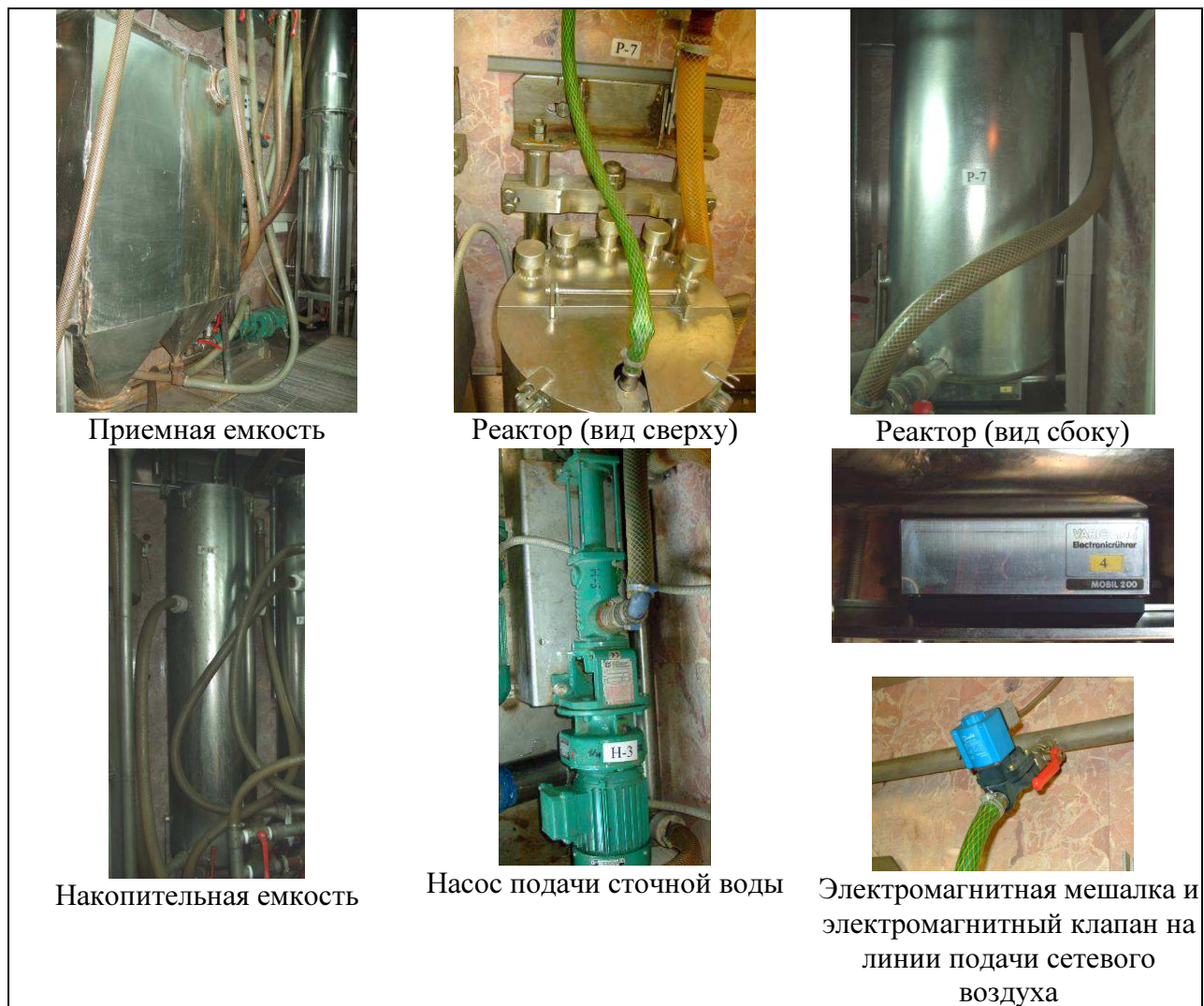
Рисунок 3.2 - Внешний вид установленного оборудования на полупромышленном реакторе циклического действия
