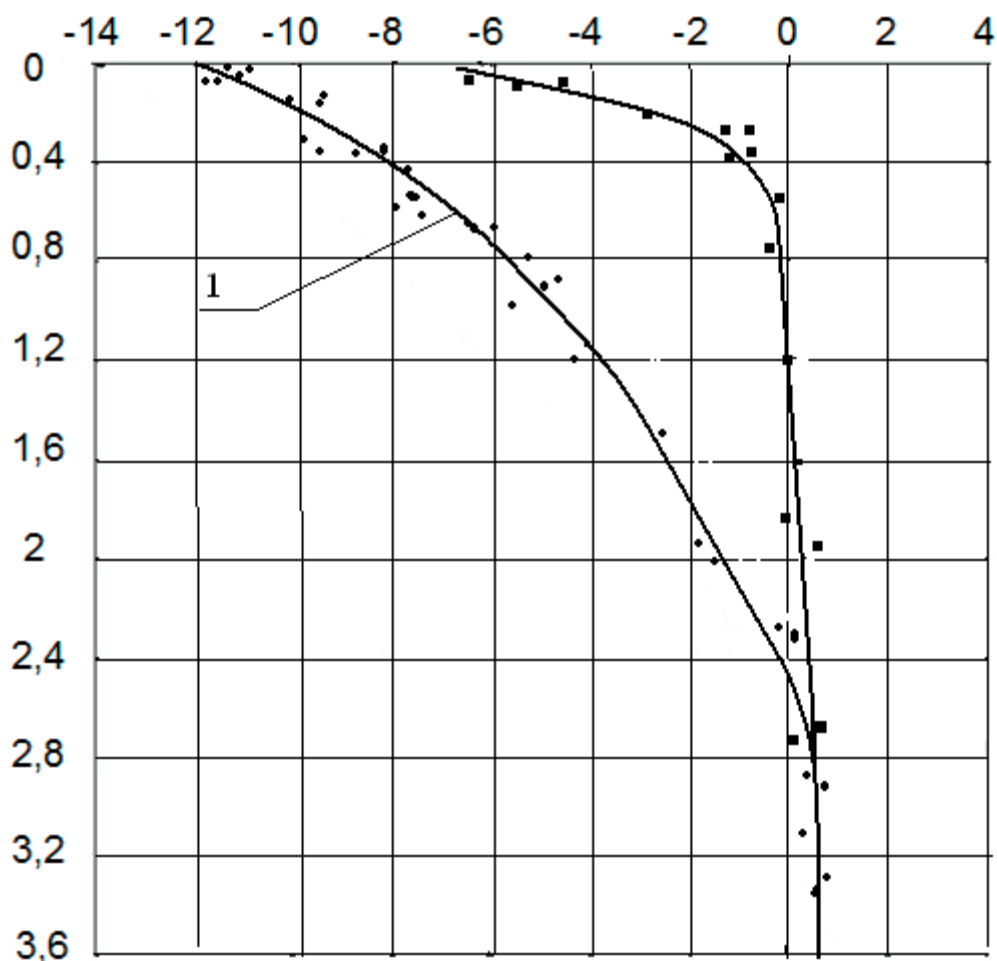
Рисунок 6.27 – Изменение температуры глины влажностью 12–23 % по глубине залегания T4: 1 – в условиях естественного промерзания; 2 – в условиях утепления карбамидным поропластом
