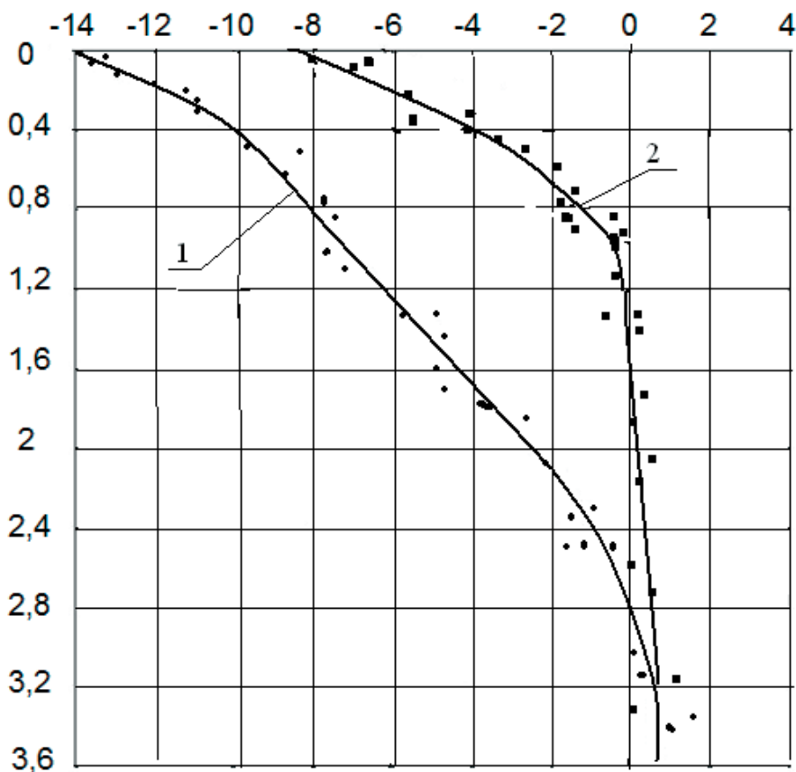
Рисунок 6.26 – Изменение температуры суглинка влажностью 13–20 % по глубине залегания при Т4: 1 – в условиях естественного промерзания; 2 – в условиях утепления карбамидным поропластом
