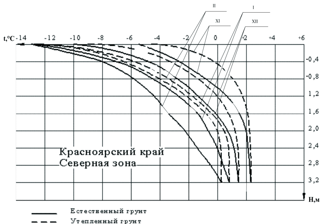
Рисунок 6.28 – Распределение температуры суглинка по глубине залегания для зимних месяцев года XI – ноябрь, XII – декабрь, I – январь, II – февраль — в условиях естественного промерзания грунта - - - - в условиях утепления грунта карбамидным пенопластом
