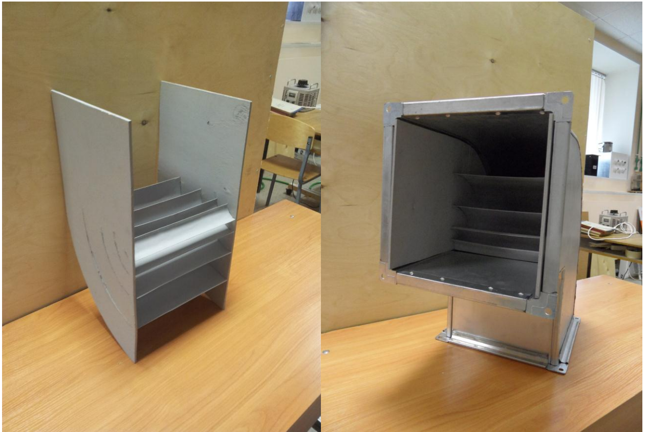
Рисунок 4.8 – Направляющие лопатки в отводе
