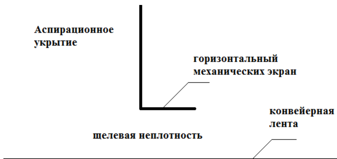
Рисунок 1.26 - Щелевая неплотность с механическим экраном
