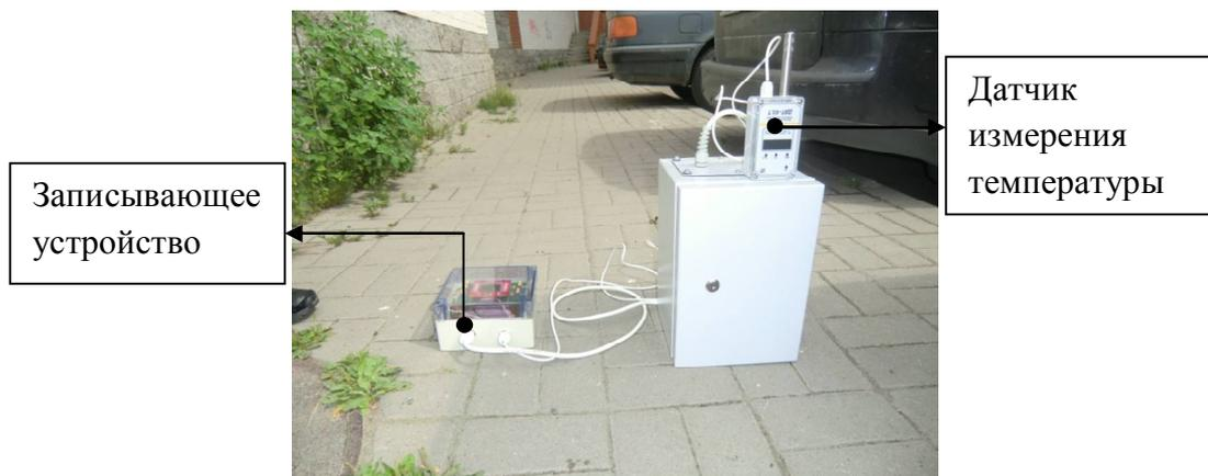
Рисунок 1.3.2.3.3 – Прибор для измерения температуры и влажности среды
