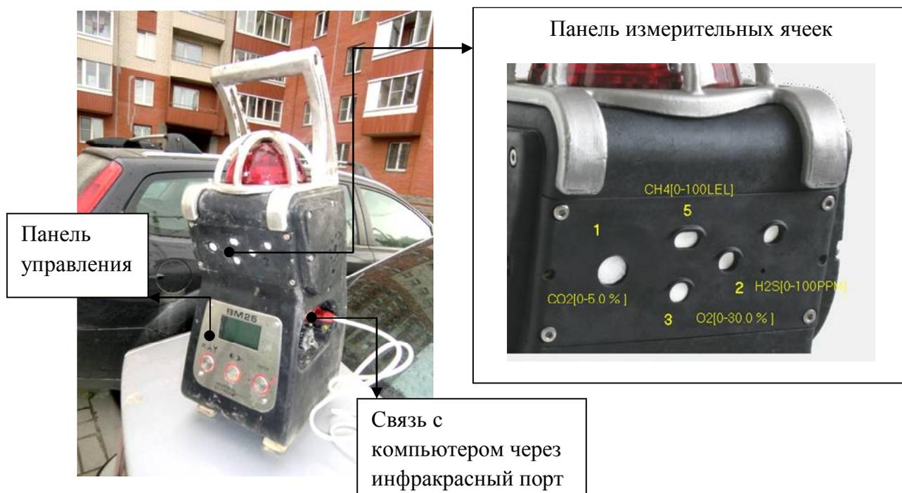
Рисунок 1.3.2.3.1 – Самопишущий газоанализатор VM-25 и его измерительные ячейки
