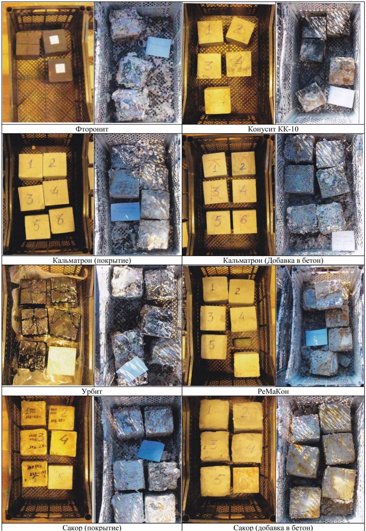
Рисунок 2.2.2.1 – Образцы бетона до и после экспонирования
