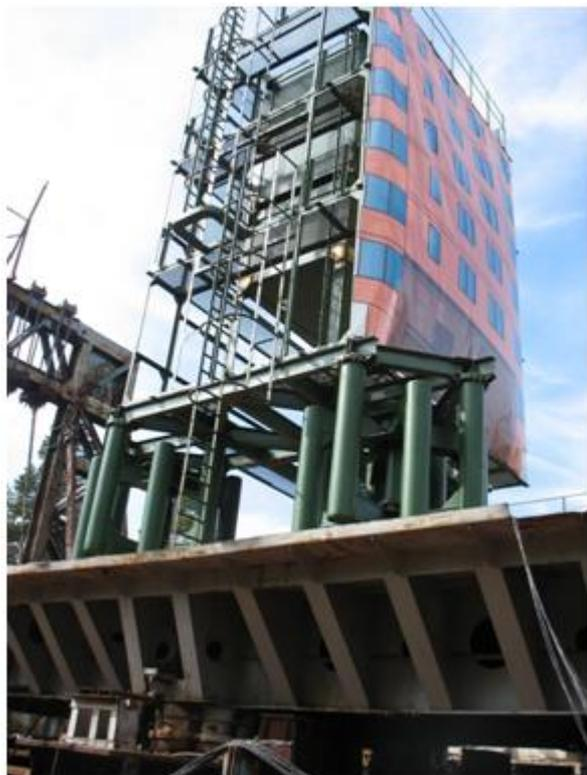
Рисунок 17 – Вид сейсмоплатформы с макетом сейсмоизолированного здания
