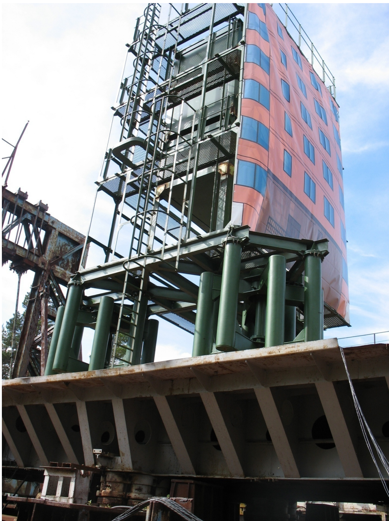
Рисунок 6.1 – Вид сейсмоплатформы с макетом сейсмоизолированного здания
