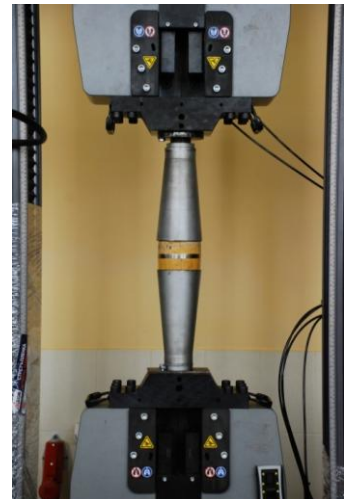
Рисунок 20 – Испытание узла на сжатие
