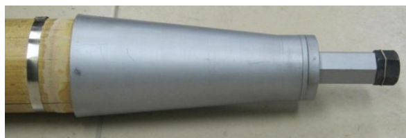
Рисунок 17 – Установка стальных элементов узла
