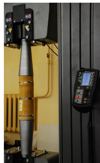
Рисунок 18 – Испытание узла на растяжение
