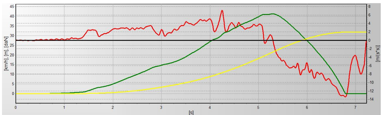
Рисунок Д. 11 – Тормозная диаграмма мотоцикла марки Yamaha FZ1 при комбинированном торможении, снаряженная масса + 40 кг груза, коэффициент сцепления 0,8 ( J_{уст}=7,7 \text{ м/с}^2 , t_3=0,55\text{с} )
