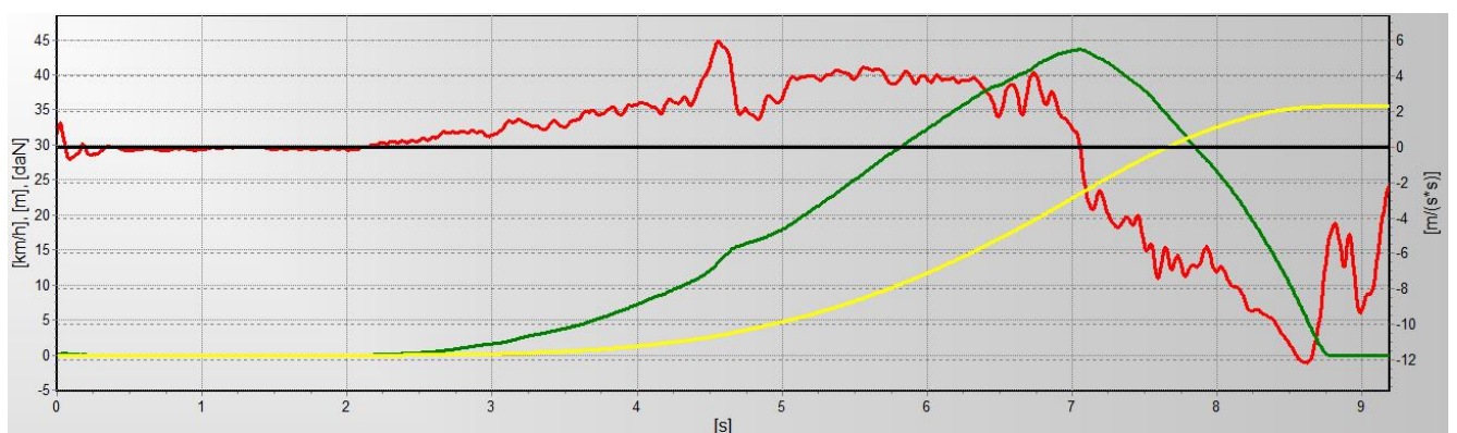
Рисунок Д. 12 – Тормозная диаграмма мотоцикла марки Honda Valkyrie F6C при комбинированном торможении, снаряженная масса + пассажир, коэффициент сцепления 0,7 ( J_{уст}=7,4 \text{ м/с}^2 , t_3=0,5\text{с} )
