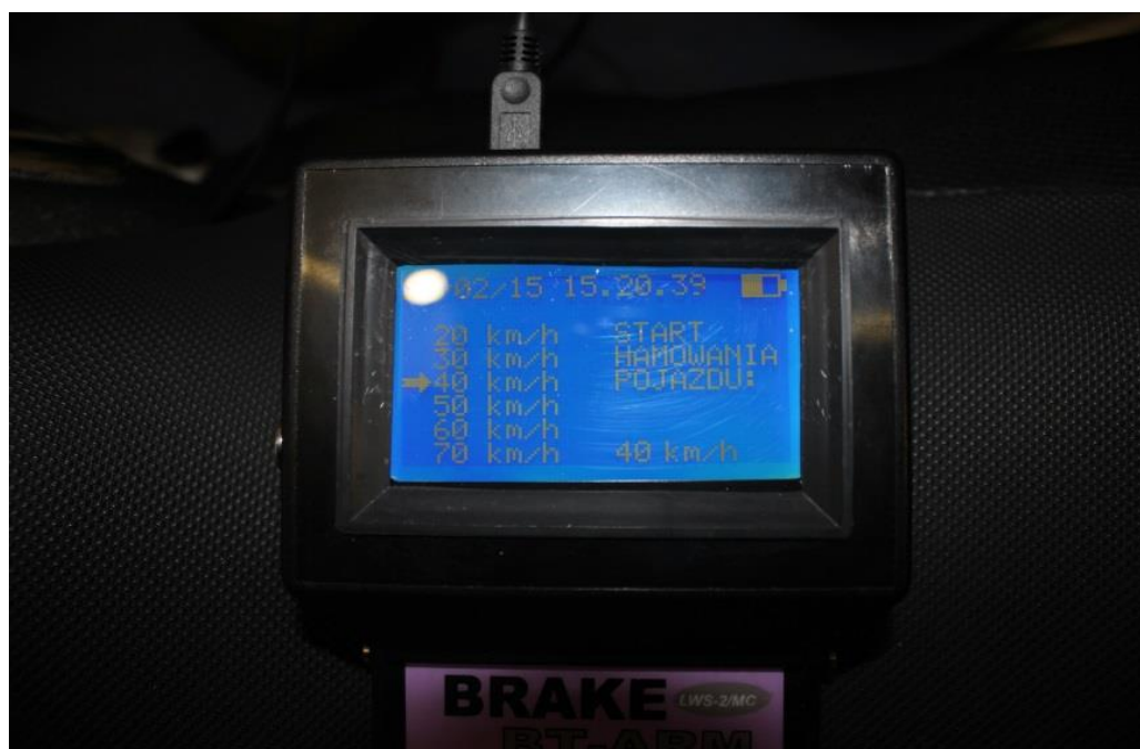
Рисунок 3.4 – Установка необходимой скорости движения для проведения исследования, в момент начала торможения, 40 км/ч
