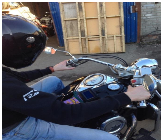
Рисунок 3.13 – Расположение деселерометра модели LWS-2MC на мотоцикле марки Yamaha XVS 1100 Drag Star Classic
