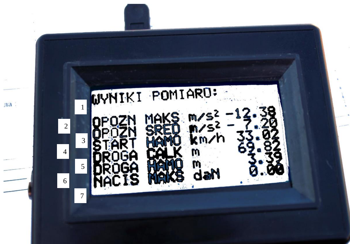
Рисунок 3.7 – Информационное табло деселерометра модели LWS-2MC после единичного заезда на мотоцикле марки Yamaha XVS 1100 Drag Star Classic при комбинированном торможении, где: 1- результаты измерения; 2 – максимальное замедление 12,38 \text{ м/с}^2 ; 3 – установившееся замедление 7,20 \text{ м/с}^2 ; 4 – скорость в момент торможения 33,02 \text{ км/ч} ; 5 – расстояние, пройденное мотоциклом с начала движения до полной остановки 69,82 \text{ м} ; 6 – тормозной путь мотоцикла 3,39 \text{ м} ; 7 – тормозное усилие, приложенное к педали тормоза, кН.
