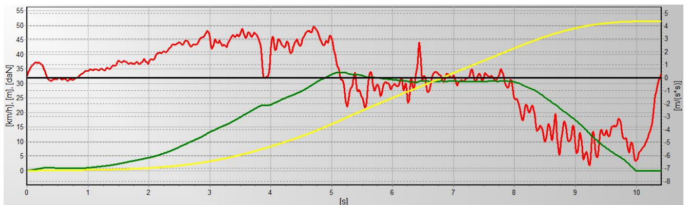
Рисунок Д. 9 – Тормозная диаграмма мотоцикла марки Yamaha FZ6 при торможении ножным приводом, снаряженная масса + пассажир, коэффициент сцепления 0,4 ( J_{уст}=4,8 \text{ м/с}^2 , t_3=0,55\text{с} )
