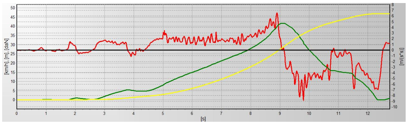
Рисунок Д. 8 – Тормозная диаграмма мотоцикла марки Suzuki V-Strom DL 1000 при торможении ручным приводом, снаряженная масса + пассажир и 20 кг груза, коэффициент сцепления 0,6 ( J_{уст}=3,6 \text{ м/с}^2 , t_3=0,3\text{с} )
