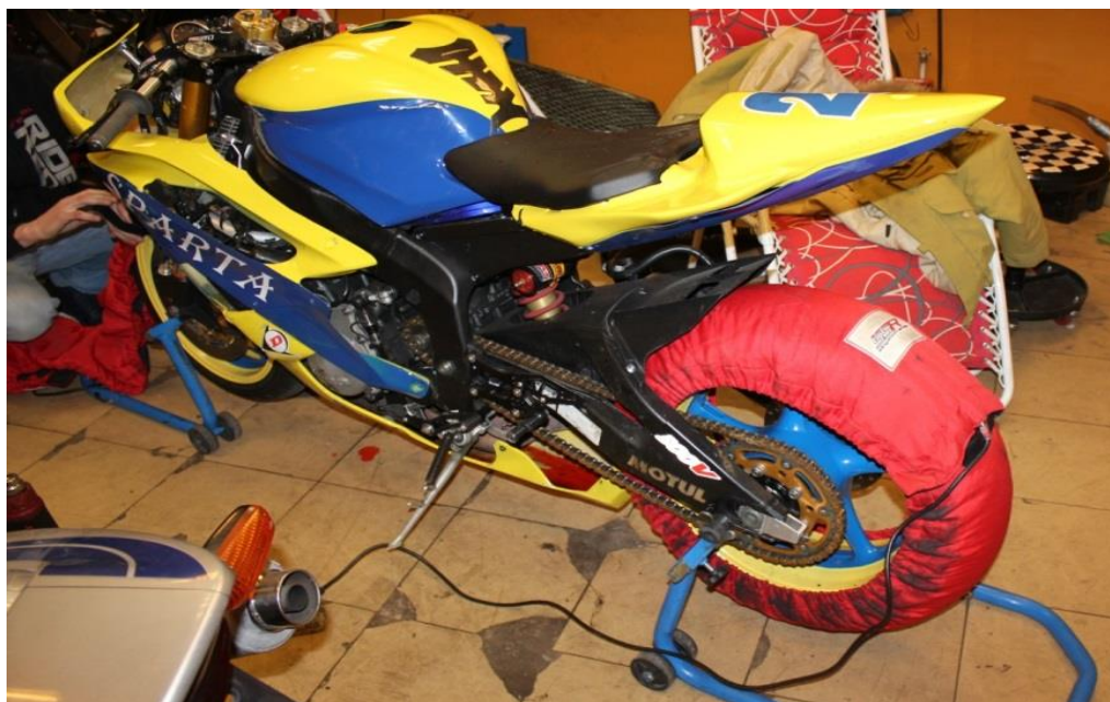
Рисунок 3.3 – Прогрев внешнего слоя шин мотоцикла марки Yamaha YZF R6 до температуры около 80 °С
