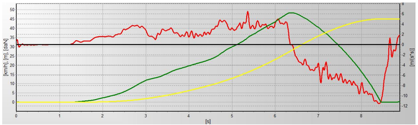
Рисунок Д. 10 – Тормозная диаграмма мотоцикла марки Yamaha GTS 1000 при комбинированном торможении, снаряженная масса + 40 кг груза, коэффициент сцепления 0,4 ( J_{уст}=6,8 \text{ м/с}^2 , t_3=0,4\text{с} )
