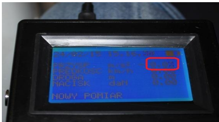
Рисунок 3.6 – Регулировка датчика замедления в горизонтальной плоскости перед началом выполнения эксперимента, отклонение датчика замедления составляет -0,03 \text{ м/с}^2 относительно линии горизонта
