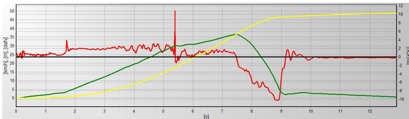
Рисунок Д. 3 – Тормозная диаграмма мотоцикла марки Honda VFR750 при торможении ручным приводом, снаряженная масса + 20 кг груза, коэффициент сцепления 0,5 ( J_{уст} = 7,2 \text{ м/с}^2 , t_3 = 0,75 \text{ с} )
