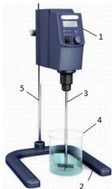
Рис. 2.3. Перемешивающее устройство: 1 – привод устройства; 2 – платформа прибора; 3 – мешалка с лопастями; 4 – стакан с обрабатываемой водой; 5 – штатив.
